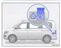
Fig. 208 230-volt external socket.
