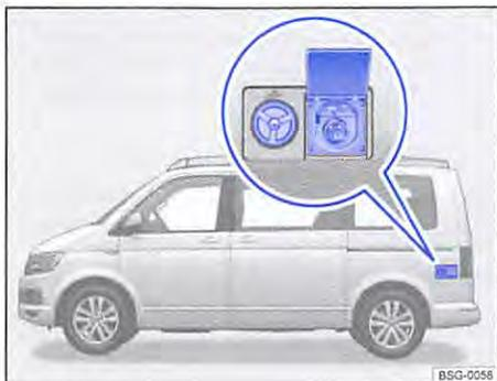
Fig. 208 230-volt external socket.
