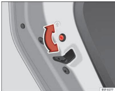
Fig. 53 Childproof lock on the left hand side door
