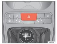
Fig. 101 The Start-Stop function button.
