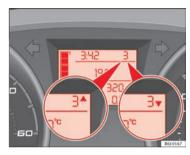
Fig. 33 Gear display
