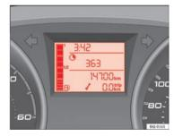
Fig. 37 Service interval display
