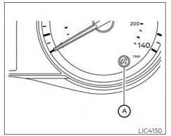
Type A (if so equipped) **INSTRUMENT BRIGHTNESS** CONTROL
