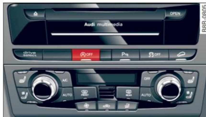
Fig. 106 Center console: Start-Stop-System button
