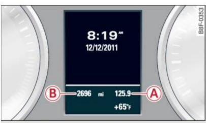
Fig. 5 Instrument cluster: odometer
