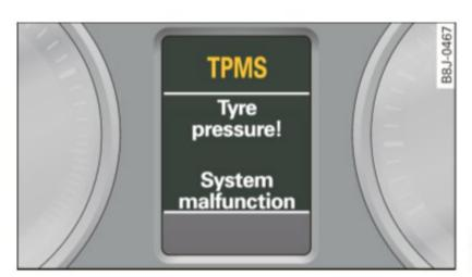
Fig. 187 Display: System malfunction
