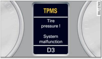
Fig. 173 Display: System malfunction
