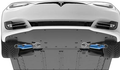
2. アンダーボディを損傷しないよう保護できるもの（木材など）を牽引用ストラップとアンダーボディの間に設置してください。
