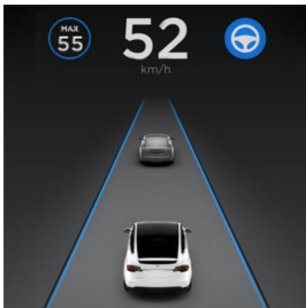
**注:** 前方に車両がない場合にオートステアリングを起動するには、車線マーカ―が見えている車道を時速 30 km 以上の速度で走行していなければなりません。前方に車両が検出された場合は、たとえ静止していても(車両から少なくとも 150 cm 離れている場合)、オートステアリングを時速 150 km 未満の任意の速度で開始することができます。
