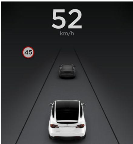
スピードアシストが制限速度を判別できない場合（たとえば、速度標識やGPS データがその位置で利用できない場合）や取得した制限速度が正しいかどうか分からない場合（たとえば、最初に速度標識が認識されてからしばらくの間次の標識が認識されない場合）、インストゥルメントパネルに速度制限は表示されず、警告も発せられません。
