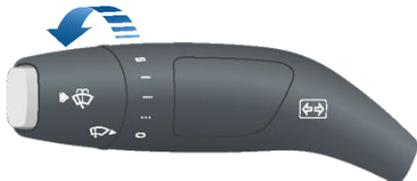
ワイパーを1回だけ動かすには、レバーの先端を押して離します。
