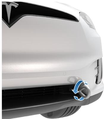
4. 牽引ボルトにウィンチケーブルを取り付けます。
