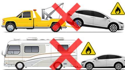
Tesla が指定していない方法で Model X の輸送を行わないでください。以下のセクションに示す指示に従い、記載されるすべての警告および注意事項を厳守してください。誤った方法で輸送中に発生した車両の損傷は保証対象にはなりません。
