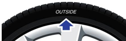
**▲ 警告:** タイヤにホイールが正確に取り付けられないと、ロードホールディング性能が著しく損なわれます。
