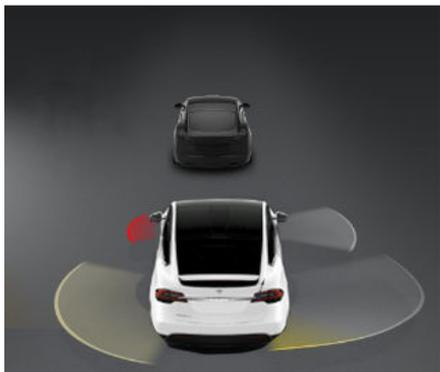
また、レーンアシストは行おうとしている車線変更が適切でない時にも警告を出します。方向指示器を点灯させて移動しようとしている隣接レーンに車両や物体が検知されると、「インストゥルメントパネル」に車両や物体が検知されたことを示す赤いレーンラインが表示されます。その車線や物体が検出されなくなると、車線は通常表示に戻ります。
