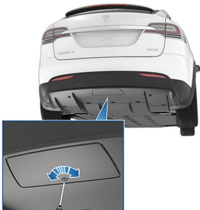
**注:** Model X 後期型では、プッシュクリップを2個使用してダストカバーを車両に固定します。開くには、マイナスドライバーなど先の尖った工具で慎重にクリップを開きます。ダストカバーを外します。
