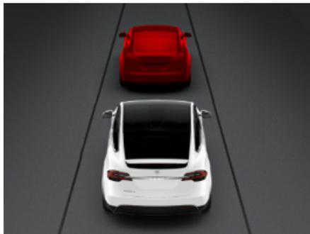
警告は衝突の危険性が低くなったときに自動的に停止します (例えば Model X を減速または停止した場合や、前方の車両が Model S の進路から外れた場合など)。
