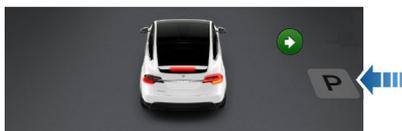
**注：**パーキングアイコンは、車両の位置および/または車両の周囲で適切な運転経路を検出した時のみ表示されます。オートパーキングが適切な経路を検出できない場合（例えば、幅の狭い道路で駐車スペースに入ろうとすると車両の前部が隣接する車線をはみ出してしまうなど）は、車両の位置を変えるか、他の駐車スペースを探るか、手動で駐車してください。
