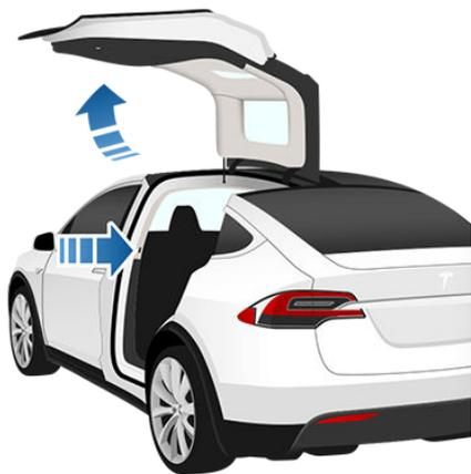
**Remarque :** Si le Model X est verrouillé, la première activation de l'interrupteur (illustration ci-dessus) déverrouille la portière concernée. La deuxième activation ouvre la portière.
