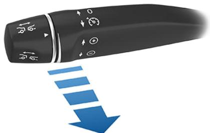
Pour reprendre le contrôle du véhicule à la vitesse actuelle, levez ou abaissez le levier du régulateur de vitesse avant de le relâcher
