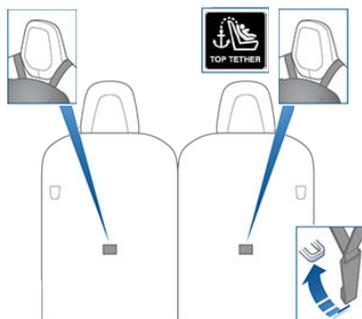
Positionnez les attaches à sangle unique au niveau des positions assises latérales de sorte à les faire passer au-dessus du côté extérieur de l'appuie-tête (du même côté de l'appuie-tête que mécanisme d'enroulement de la ceinture de sécurité). Pour le siège central (le cas échéant), centrez et faites passer la sangle par-dessus l'appuie-tête.
