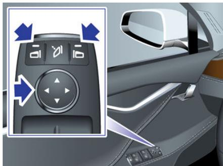
Pour rabattre et déployer les rétroviseurs extérieurs, appuyez sur le bouton central. Vous pouvez paramétrer les rétroviseurs pour qu'ils se rabattent automatiquement lorsque vous verrouillez votre Model X. Pour cela, touchez **Contrôles > Véhicule > Rabattement auto**. Les rétroviseurs se déploient automatiquement dès le déverrouillage de votre Model X.
