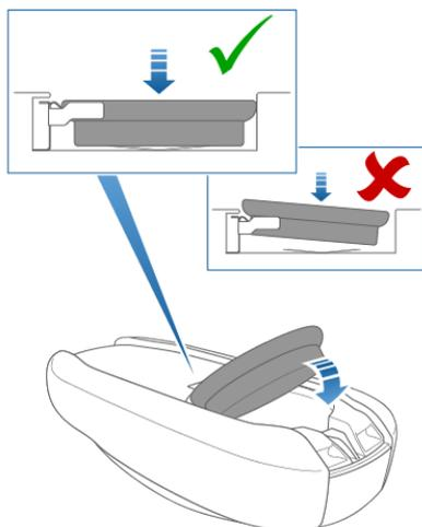
**Remarque :** Essayez la batterie avant de l'installer et évitez de toucher les surfaces planes de la batterie. Des traces de doigts sur les surfaces planes de la batterie peuvent réduire sa durée de vie.
