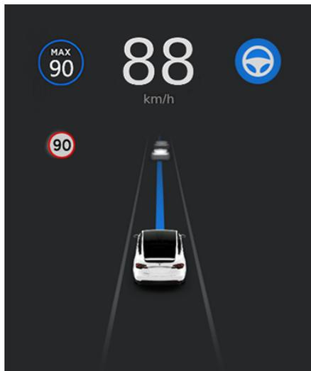
Lorsque la fonction Navigation Autopilot est active et que vous approchez d'une sortie ou d'un échangeur sur votre itinéraire, le clignotant s'active et l'Assistance au maintien de cap manœuvre votre Model X pour emprunter la sortie ou l'échangeur.
