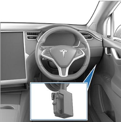
4. Branchez le connecteur à nattes sur le connecteur de câblage du véhicule.
