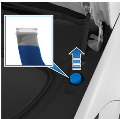
4. En évitant les déversements, remplissez le réservoir jusqu'à ce que le niveau du liquide affleure tout juste sous le goulot de remplissage.
