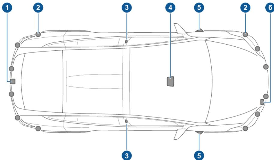
1. Une caméra est montée au-dessus de la plaque d'immatriculation arrière.
