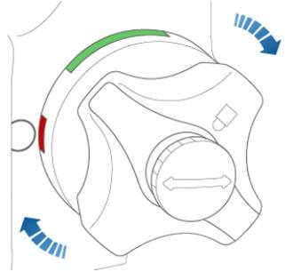
**⚠ Avertissement :** Faites attention lorsque vous tournez le cylindre de verrouillage. S'il ne se verrouille pas en « position ouverte », il revient automatiquement à sa « position fermée » d'origine et vous risquez alors de vous coincer les doigts.
