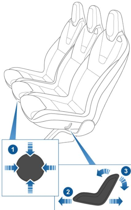
1. Faites avancer/reculer le siège (haut/bas sur l'interface de contrôle) et réglez le dossier (gauche/droite sur l'interface de contrôle).
