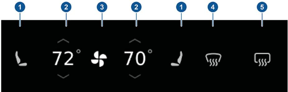
1. Les sièges chauffants fonctionnent selon trois niveaux de réglage, de 3 (plus élevé) à 1 (plus bas). Lorsque cette fonction est activée, l'icône de siège associée affiche des lignes ondulées qui deviennent rouges pour indiquer le niveau réglé. Si le véhicule est doté de sièges ventilés, une fenêtre contextuelle s'affiche, pour vous permettre de passer du chauffage au refroidissement et vice-versa. Lors du refroidissement, les lignes ondulées passent au bleu.
