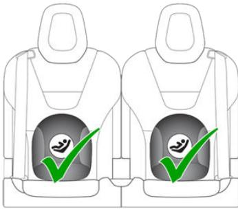
Pour installer un siège de sécurité pour enfants retenu par système ISOFIX, faites glisser les loquets du siège de sécurité sur les barres d'ancrage jusqu'à ce qu'ils s'enclenchent avec un déclic. Lisez et suivez attentivement les instructions fournies par le fabricant du siège de sécurité pour enfants.
