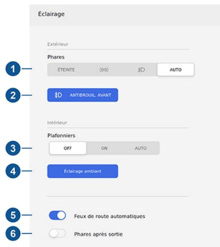
1. L'éclairage extérieur (phares, feux arrière, feux latéraux, feux de stationnement et éclairage de la plaque d'immatriculation) est réglé sur **AUTO** dès que vous démarrez votre Model X. En position **AUTO**, l'éclairage extérieur s'allume automatiquement lorsque vous conduisez sur des routes mal éclairées. Si vous changez de paramètre, l'éclairage repasse toujours sur **AUTO** au trajet suivant.
