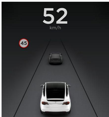
Lorsque l'Indicateur de limite de vitesse ne parvient pas à détecter de limite de vitesse (panneaux de signalisation ou données GPS indisponibles pour la position actuelle, par exemple), ou lorsqu'il n'est pas certain de la limite de vitesse détectée (en cas d'absence de panneau pendant un certain temps, par exemple), le tableau de bord peut ne pas afficher de signal de limite de vitesse et les avertissements ne sont pas actifs.
