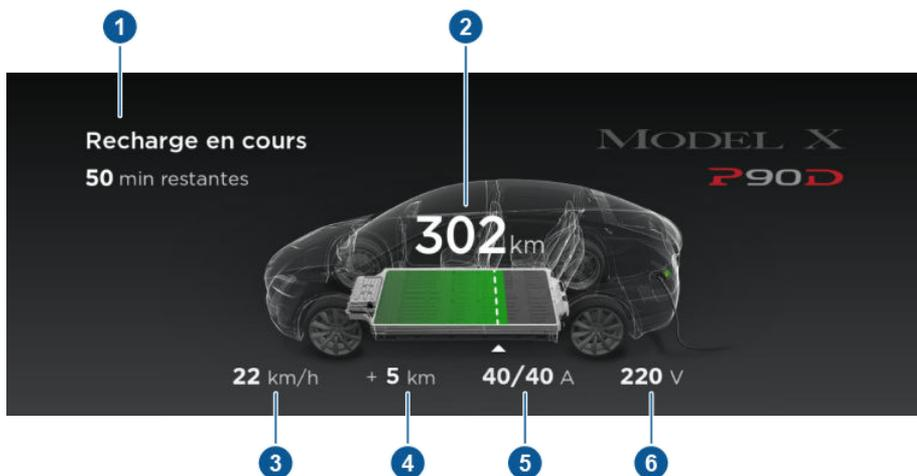
1. Informations sur l'état de la recharge. Par exemple, lorsque la Model X est en cours de recharge, elle affiche la durée restante jusqu'à la recharge complète de la batterie au niveau de recharge actuel. Lorsqu'une session de recharge est programmée, l'heure de début de la recharge est affichée.
