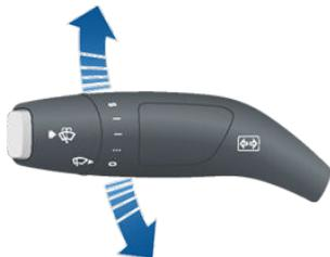
Les clignotants cessent de fonctionner lorsque le volant revient en position droite ou lorsque vous replacez le levier dans sa position centrale.
