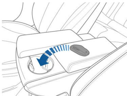
Si la Model X ne parvient toujours pas à détecter la clé, essayez de la maintenir contre la console centrale, juste en dessous de la prise de courant 12 V (voir [Prise de courant 12 V](#) à la page 23). Si la clé n'est toujours pas détectée, retirez la pile de celle-ci et réessayez. Voir [Remplacement de la pile de la clé](#) à la page 11. Ou essayez avec une autre clé. Si une autre clé ne fonctionne pas, contactez Tesla.
