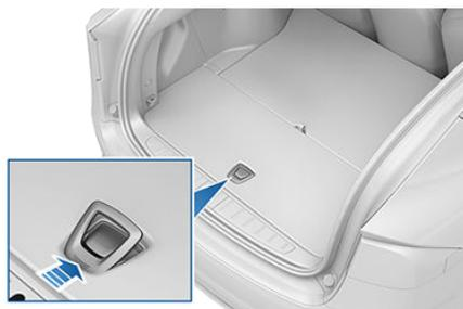
**⚠ Attention :** Ne placez jamais de charges supérieures à 175 lbs (80 kg) sur le plancher de chargement arrière (au-dessus du compartiment de coffre inférieur) ou de plus de 285 lbs (130 kg) dans le compartiment de coffre inférieur. Ceci risque d'entraîner des dommages.
