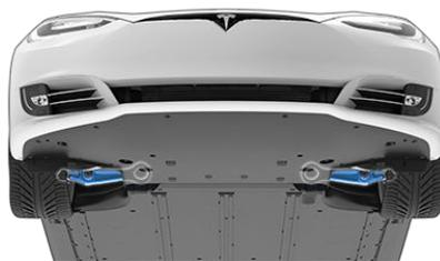
2. Pour protéger le soubassement de tout dommage, placez un élément (par exemple, un morceau de bois) entre les sangles et le soubassement.
