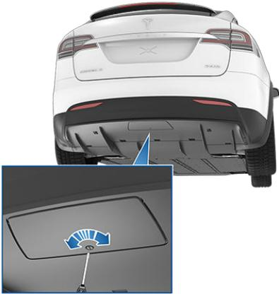
**Remarque :** Les versions plus récentes du Model X disposent de deux agrafes poussoirs pour fixer la protection au véhicule. Pour les ouvrir, utilisez un objet tranchant tel qu'un tournevis à tête plate puis soulevez délicatement les agrafes. Retirez la protection.
