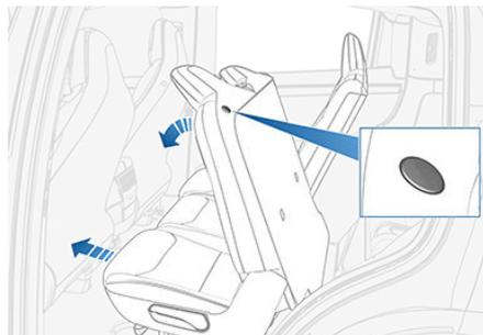
Dans certaines situations, comme lorsque le véhicule est garé sur une pente ou lorsque la garniture de siège gêne les mouvements des banquettes, après avoir appuyé sur le bouton de la fonction Accès facile, les banquettes peuvent ne pas se déplacer complètement vers l'avant et vous devrez les pousser délicatement vers l'avant jusqu'à ce qu'elles atteignent la fin de course.
