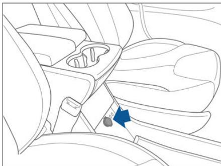
Prises de courant 12 V : pour accessoires disposant au maximum d'une alimentation 11 A continue (pic : 15 A) ou d'une puissance maximale de 150 W continue (pic : 180 W).
