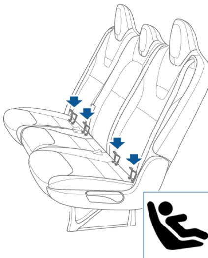
Sur la deuxième rangée, installez les sièges de sécurité pour enfants retenus par système ISOFIX aux places latérales uniquement. Sur le siège central, utilisez toujours un siège retenu par ceinture de sécurité.
