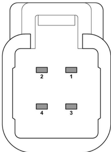
1 - Sortie du système de contrôle de frein à la remorque.
