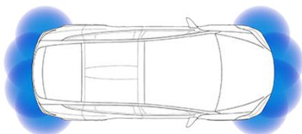
**Remarque :** Les capteurs arrière sont désactivés lorsqu'un vélo est détecté ou que la Model X est en mode Remorque.
