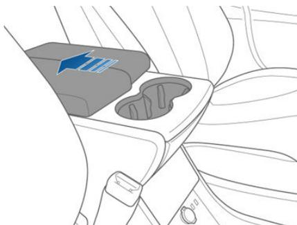
Pour dégager les porte-gobelets arrière (selon l'équipement), appuyez brièvement sur la façade des porte-gobelets, située au dos de la console centrale.
