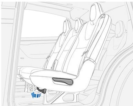
**Nota:** Usted puede ajustar la posición de los asientos corridos utilizando solo las palancas mecánicas. No puede utilizar la pantalla táctil para ajustar los asientos corridos.
