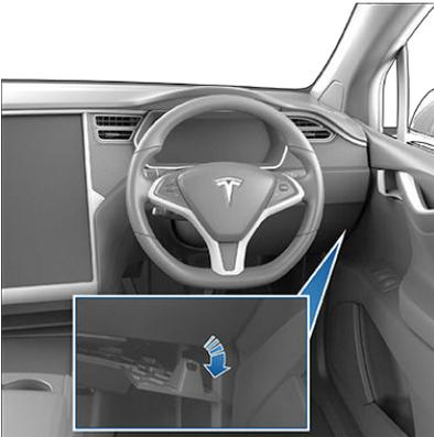
3. Retire la alfombrilla para ver el conector de 4 patillas del Model X en el mazo de cables.
