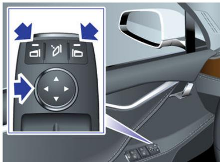
Para plegar y desplegar los retrovisores exteriores, presione el botón central. Puede ajustar los retrovisores para plegarse automáticamente cada vez que Model X se bloquee tocando **Controles > Vehículo > Plegado automático de espejos**. Los retrovisores se despliegan automáticamente cada vez que abra el Model X.
