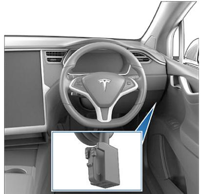
4. Conecte el conector flexible al conector de cableado del vehículo.
