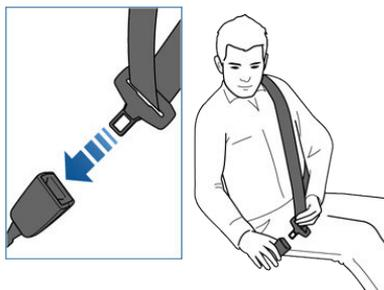
4. Tire del cinturón para asegurarse de que haya quedado fijado firmemente.
