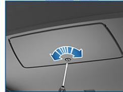
**Nota:** Las versiones más recientes del Model X cuentan con dos broches de presión para sujetar la cubierta antipolvo al vehículo. Para abrirlos, use un objeto filoso, tal como un desarmador plano, para forzar cuidadosamente que los broches se abran. Retire la cubierta antipolvo.
