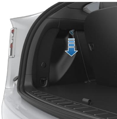
**Nota:** El cable de liberación puede estar metido dentro de la apertura de la moldura.
