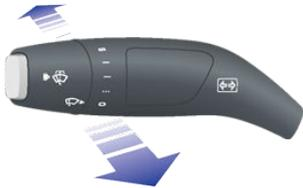
Las luces largas pueden cambiar automáticamente a luces de cruce si se detecta luz delante del Model X (por ejemplo, procedente de un vehículo circulando en dirección contraria). Para encender o apagar esta función, toque **Controles > Luces > Luces Altas Automáticas**.
