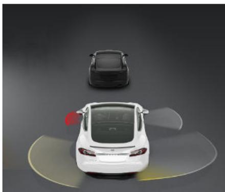
A assistência à manutenção na faixa de rodagem também o alerta quando uma faixa de rodagem pretendida não é adequada. Quando ativa um dos sinais de mudança de direção e é detetado um veículo ou objeto na faixa adjacente para a qual se pretende deslocar, o painel de instrumentos apresenta uma linha de faixa vermelha para indicar que um veículo ou objeto foi detetado. Quando veículo ou o objeto deixam de ser detetados, a linha de faixa regressa ao normal.
