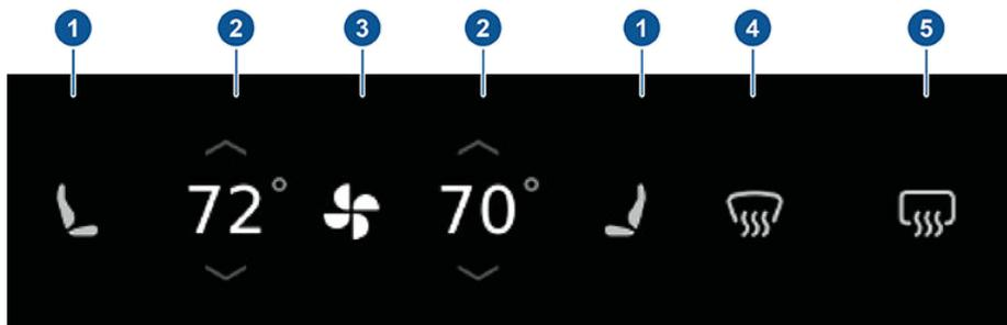
1. Os aquecedores dos bancos funcionam com três níveis de definição entre 3 (o mais alto) até 1 (o mais baixo). Quando os utiliza, o ícone de banco associado apresenta linhas ondulantes que se acendem a vermelho para indicar o nível de definição. Se o veículo estiver equipado com bancos ventilados, aparece uma janela pop-up que permite alternar entre aquecimento e arrefecimento. Durante o arrefecimento, as linhas ondulantes acendem a azul.
