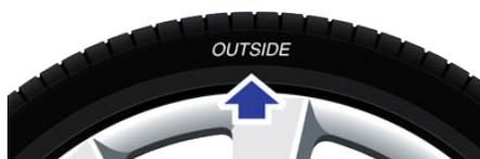
**⚠ Aviso:** A aderência à estrada é seriamente comprometida se os pneus estiverem incorretamente instalados nas jantes.
