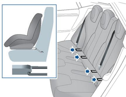
Uma vez instalada, teste a segurança da instalação antes de colocar uma criança. Tente rodar a cadeira de segurança para crianças de um lado para o outro e experimente puxá-la para fora do banco e, em seguida, verifique se as fixações se mantêm na posição.
