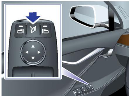
O espelho do lado do condutor escurece automaticamente à noite de acordo com o nível de brilho dos faróis de um veículo atrás de si (exceto se estiver em marcha-atrás). Além disso, ambos os espelhos laterais exteriores possuem aquecedores que se ligam e desligam com o desembaciador do vidro traseiro.
