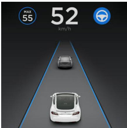
**Nota:** Para iniciar a direção automática se não estiver qualquer veículo à sua frente, deve estar a conduzir a pelo menos 30 km/h numa estrada com marcações de faixa visíveis. Se for detetado um veículo à sua frente, pode utilizar a direção automática a qualquer velocidade inferior a 150 km/h, mesmo parado (se estiver a uma distância de, pelo menos, 150 cm do veículo).
