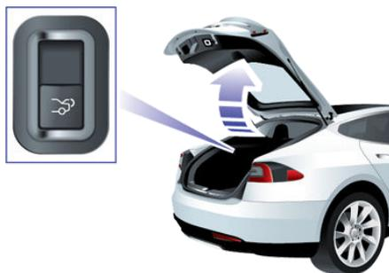
Se o Model S estiver equipado com porta da bagageira elétrica, não é necessário empurrá-la para cima. Abre-se ao premir o interruptor de abertura e fecha-se quando puxa o interruptor.
