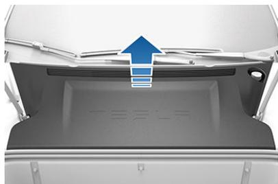
**⚠ Cuidado:** O painel de manutenção protege a bagageira dianteira de água. Quando o voltar a fixar, certifique-se de que está bem encaixado.
