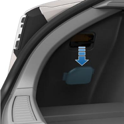
4. Mantenha a alavanca de libertação manual da porta de carregamento empurrada na direção da dianteira do veículo para desencaixar o cabo de carregamento.
