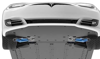
2. Para proteger a parte inferior da carroçaria de danos, coloque uma barreira de proteção (como um pedaço de madeira) entre a correia de reboque e a parte inferior da carroçaria.
