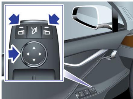
Para recolher e abrir os espelhos exteriores, prima o botão central. Pode definir os espelhos para recolherem automaticamente sempre que o Model S for trancado tocando em **Controlos > Vehicle > Mirror Auto-Fold**. Os retrovisores abrem-se automaticamente sempre que destrancar o Model S.
