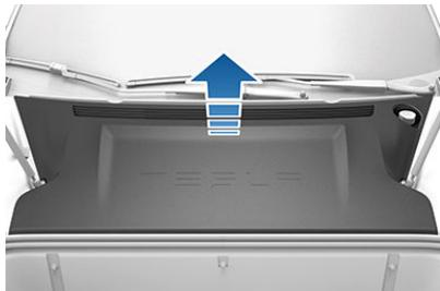
**⚠ Avvertenza:** il pannello per la manutenzione protegge il vano bagagli anteriore dall'ingresso di acqua. In fase di riposizionamento, verificare che sia correttamente bloccato.
