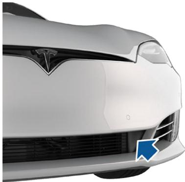
**Nota:** Conservare il coperchio dell'occhiello di traino in un luogo sicuro così da poterlo riposizionare una volta completato il traino.
