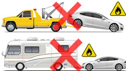
Non trasportare la Model S utilizzando un metodo diverso da quello specificato da Tesla. Seguire le istruzioni fornite nelle sezioni seguenti e rispettare tutte le avvertenze e le precauzioni fornite. I danni causati da un trasporto improprio del veicolo non sono coperti dalla garanzia.
