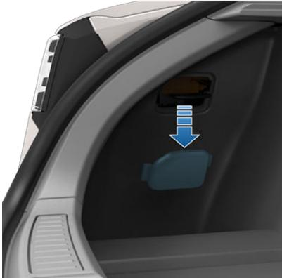
4. Tenere premuta la leva di rilascio manuale della presa per la ricarica verso la parte anteriore del veicolo per sbloccare il cavo di ricarica.
