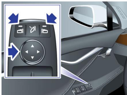
Per chiudere e aprire i retrovisori esterni, premere il pulsante centrale. Per impostare la chiusura automatica dei retrovisori esterni quando ci si allontana dalla Model S, toccare **Comandi > Veicolo > Retrovisore ripiegabile automaticamente**. I retrovisori si aprono automaticamente sbloccando la Model S.
