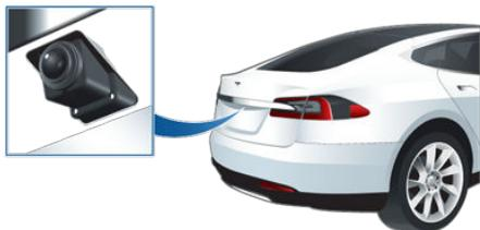
Ogni volta che si innesta la retromarcia, sul touchscreen viene visualizzata la vista della telecamera. Le linee mostrano il percorso di marcia in base alla posizione del volante. Tali linee si adattano a seconda del movimento del volante.
