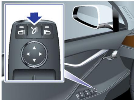
Il retrovisore esterno del conducente si regola automaticamente di notte, in base al livello di riverbero prodotto dai fari dei veicoli che seguono (tranne quando è inserita la retromarcia). Entrambi i retrovisori esterni sono inoltre dotati di riscaldatori che si attivano e disattivano insieme al sistema di sbrinatorio del lunotto.
