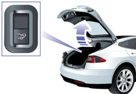
Se la Model S è dotata anche di portellone elettrico, non è necessario spingere verso l'alto. Premere l'interruttore di apertura per aprire, rilasciarlo per chiudere.
