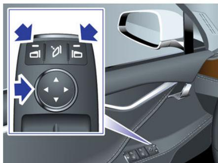
Pour rabattre et déployer les rétroviseurs extérieurs, appuyez sur le bouton central. Vous pouvez paramétrer les rétroviseurs pour qu'ils se rabattent automatiquement lorsque vous verrouillez votre Model S. Pour cela, touchez **Contrôles > Véhicule > Rabattement auto**. Les rétroviseurs se déploient automatiquement dès le déverrouillage de votre Model S.
