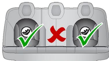
Pour installer un siège de sécurité pour enfants retenu par système ISOFIX, faites glisser les loquets du siège de sécurité sur les barres d'ancrage jusqu'à ce qu'ils s'enclenchent avec un déclic. Lisez et suivez attentivement les instructions fournies par le fabricant du siège de sécurité pour enfants.
