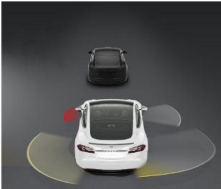
L'Aide au maintien de voie vous avertit également lorsqu'un franchissement de ligne volontaire n'est pas approprié. Lorsque vous enclenchez le clignotant et qu'un véhicule ou un objet est détecté dans la voie adjacente visée, le tableau de bord affiche une ligne de voie rouge pour indiquer qu'un véhicule ou un objet est détecté. Lorsque le véhicule ou l'objet n'est plus détecté, la ligne de voie s'affiche de nouveau normalement.
