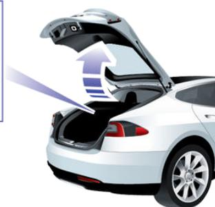
Si la Model S est équipée du hayon électrique, il n'est pas nécessaire de le soulever manuellement. Lorsque vous appuyez sur la commande de déverrouillage, le hayon s'ouvre, et lorsque vous tirez la commande vers le haut, il se ferme.
