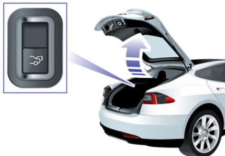
Si el Model S dispone de puerta levadiza eléctrica, no es necesario empujarla. Cuando presiona el interruptor de desbloqueo, se abre, y cuando tira del interruptor, se cierra.
