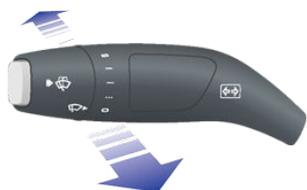
Las luces largas pueden cambiar automáticamente a luces de cruce si se detecta luz delante del Model S (por ejemplo, procedente de un vehículo circulando en dirección contraria). Para encender o apagar esta función, toque **Controles > Luces > Luces Altas Automáticas**.
