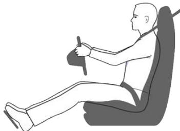
Coloque el asiento de forma que pueda utilizar correctamente el cinturón de seguridad, pero lo más alejado posible del airbag delantero:
