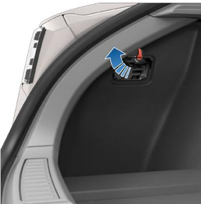
5. Jale el cable de carga del puerto de carga.
