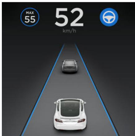
**Nota:** Para iniciar Autoviraje cuando no hay vehículos delante de usted, debe ir como mínimo a una velocidad de 30 km/h por una carretera con marcas de carril visibles. Si un vehículo frente a usted es detectado, puede iniciar Autogiro a cualquier velocidad inferior a 150 km/h, incluso cuando esté inmóvil (si usted está a por lo menos 150 cm de distancia del vehículo).
