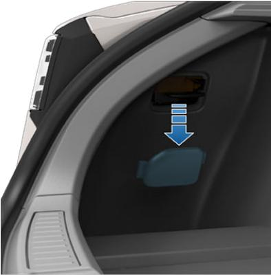
4. Oprima y sostenga la palanca de liberación manual del puerto de carga hacia el frente del vehículo para desconectar el cable de carga.
