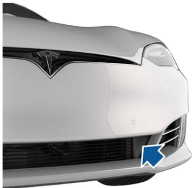
**Nota:** Guarde la tapa de la anilla de remolque en un lugar seguro para volver a colocarla una vez terminado el proceso de remolque.
