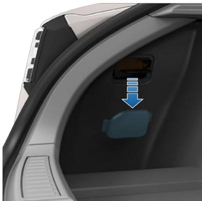
4. Drücken und halten Sie den manuellen Entriegelungshebel des Ladeanschlusses in Richtung Fahrzeugvorderseite, um das Ladekabel zu entriegeln.
