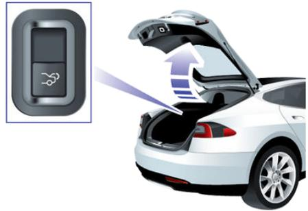
Wenn Model S mit der elektrischen Heckklappe ausgestattet ist, müssen Sie die Heckklappe nicht nach oben drücken. Wenn Sie den Öffnungsschalter drücken, wird der Kofferraum geöffnet. Wenn Sie am Schalter ziehen, wird er geschlossen.
