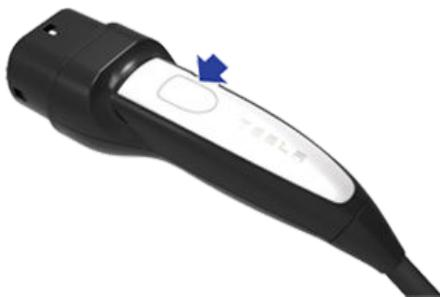
Sie können die Ladeanschlussklappe auch öffnen, indem Sie einen der folgenden Schritte durchführen:
