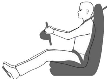
Bringen Sie den Sitz in eine Position, die möglichst weit vom Front-Airbag entfernt ist, in der Sie aber dennoch den Sicherheitsgurt korrekt anlegen können.
