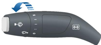
Drücken Sie kurz auf das Ende des Hebels, um den Wischer nur ein einziges Mal zu bedienen.
