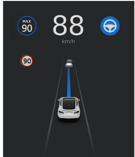
Wenn Sie sich bei aktivierter Funktion „Mit Autopilot navigieren“ entlang Ihrer Navigationsroute einer Ausfahrt oder einem Autobahnkreuz nähern, wird der entsprechende Blinker eingeschaltet und der Lenkassistent manövriert Model S in die Ausfahrt bzw. auf das Autobahnkreuz.
