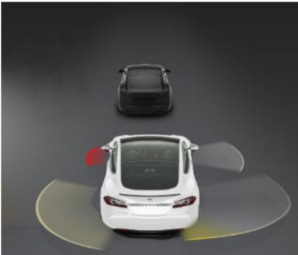
Der Spurassistent warnt Sie auch, wenn ein gewünschter Spurwechsel ungünstig ist. Wenn Sie den Blinker betätigen und in der benachbarten Spur, auf die Sie wechseln möchten, ein Fahrzeug oder ein anderes Objekt erkannt wird, wird auf der Instrumententafel eine rote Spurlinie angezeigt, die Sie darauf hinweist. Wenn das Fahrzeug oder Objekt nicht mehr erkannt wird, wechselt die Spurlinie wieder auf normal.
