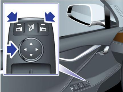
Drücken Sie auf die mittlere Taste, um die Außenspiegel ein- und auszuklappen. Wenn die Spiegel beim Verriegeln von Model S automatisch eingeklappt werden sollen, berühren Sie **Fahrzeug > Bedienung > Spiegel automatisch einklappen**. Die Spiegel werden automatisch ausgeklappt, wenn Model S entriegelt wird.
