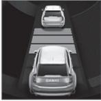
È possibile selezionare diverse distanze temporali dal veicolo antistante, che vengono visualizzate sul display del conducente con 1-5 linee orizzontali - più linee sono visualizzate, maggiore è la
