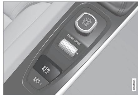
Il comando del freno di stazionamento si trova nel tunnel fra i sedili.
