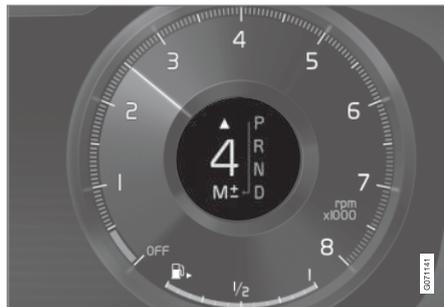
Indicatore cambio di marcia sul display del conducente da 12" per la leva selettoria grande\*.
