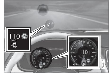
La figura precedente mostra che il Pilot Assist è impostato per mantenere una velocità di 110 km/h (68 mph) e segue un veicolo antistante che mantiene la stessa velocità.
