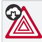
Quando l'automobile si avvicina a un veicolo con i lampeggiatori di emergenza accesi, viene visualizzato questo simbolo sul cruscotto.
