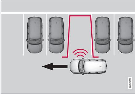
Principio per la ricerca di un parcheggio in perpendicolare.
