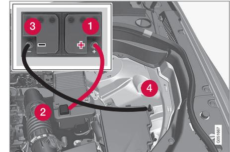
Punti di fissaggio dei cavi di avviamento. L'aspetto del vano motore può variare a seconda di modello d'auto e livello di equipaggiamento.
