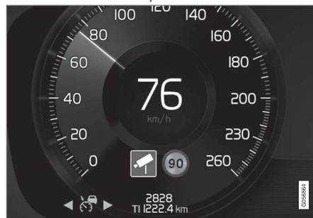
Esempio di informazioni su autovelox e limiti di velocità sul display del conducente.
