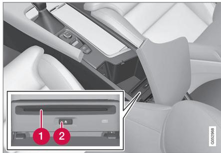
❶ Apertura di inserimento ed espulsione del disco.
