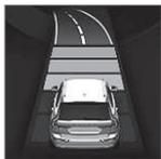
Quando la funzione riduce la velocità dell'automobile, il display del conducente visualizza questo simbolo.
