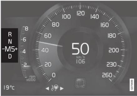
Indicatore cambio di marcia sul display del conducente da 8" per la leva selettiva piccola.
