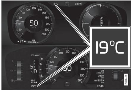
Posizione del termometro della temperatura esterna sul display del conducente da 12" e 8". La figura è schematica - i dettagli possono differire a seconda del modello di automobile.
