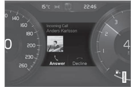
Esempio di messaggio sul display del conducente. La figura è schematica - i dettagli possono differire a seconda del modello di automobile.
