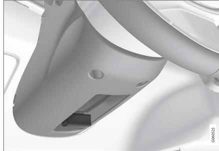
Leva per la regolazione del volante.
