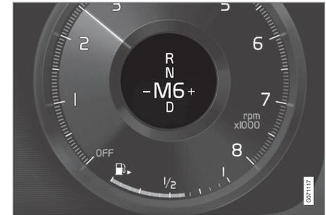
Panoramica dello schema di cambio sul display del conducente per la leva selettoria piccola.
