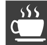
Se l'automobile continua a procedere a zigzag, il conducente viene avvertito con questo simbolo sul display del conducente combinato con un segnale acustico e il messaggio **È il momento di fare una pausa.**
