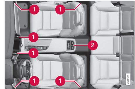
Posizione delle bocchette di ventilazione regolabili nell'abitacolo.
