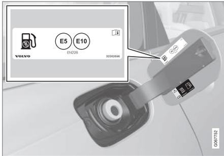
Utilizzare un carburante approvato per l'automobile, vedere l'identificatore<sup>14</sup> all'interno dello sportello del serbatoio. Per informazioni su carburanti approvati e identificatore, vedere la sezione "Benzina".
