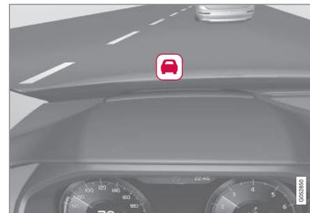
Il simbolo di allarme del City Safety lampeggia per attirare l'attenzione del conducente se sussiste il rischio di collisione.
