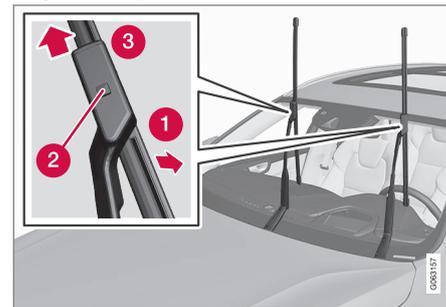
Solleverlo il braccio dei tergicristalli quando si trova in posizione di assistenza. La posizione di assistenza si attiva/disattiva dalla videata funzioni sul display centrale ad automobile ferma con i tergicristalli disinseriti.
