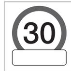
La visualizzazione di un cartello accessorio sotto forma di un riquadro vuoto sotto il segnale di velocità<sup>97</sup> sul display del conducente indica che la funzione ha rilevato un cartello accessorio con informazioni complementari per il limite di velocità attuale.
