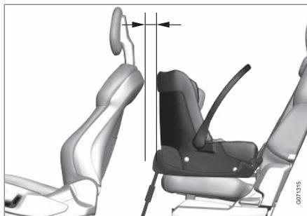
Per il montaggio di protezioni per neonati nel sedile posteriore, Volvo raccomanda di mantenere una distanza di almeno 50 mm (2 pollici) dalla parte anteriore della protezione per neonati alla parte posteriore del sedile davanti.
