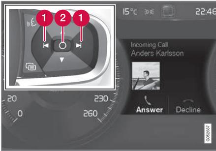
Esempio di messaggio sul display del conducente<sup>6</sup> e comandi destri al volante. La figura è schematica - i dettagli possono differire a seconda del modello di automobile.
