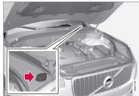
Il liquido lavacrystalli si rabbocca nel serbatoio con il tappo blu. Il serbatoio è usato sia per il lavaparbrezza che il lavafari\*
