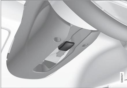
Leva per la regolazione del volante.
