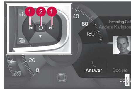
Esempio di messaggio sul display del conducente<sup>5</sup> e comandi destri al volante.
