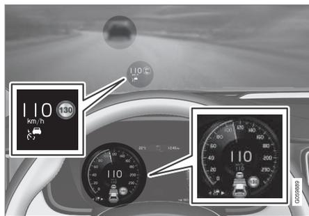
L'immagine precedente mostra che il regolatore elettronico della velocità adattivo è impostato per mantenere una velocità di 110 km/h (68 mph) e segue un veicolo antistante che mantiene la stessa velocità.
