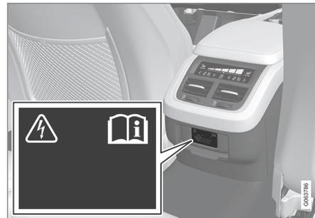
Presa elettrica nel tunnel, sedile posteriore.
