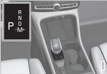
Panoramica della leva selettoria piccola e schema di cambio sul display del conducente
