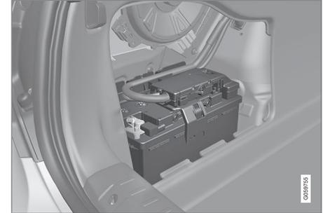
La batteria di avviamento si trova nel bagagliaio.
