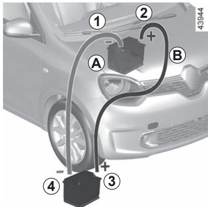
Accione o motor de arranque. Logo que pegue, desligue os cabos **A** e **B** pela ordem inversa (**1 - 4 - 3 - 2**) e coloque o capô de protecção vermelho pressionando uma pressão superior, para baixo.
