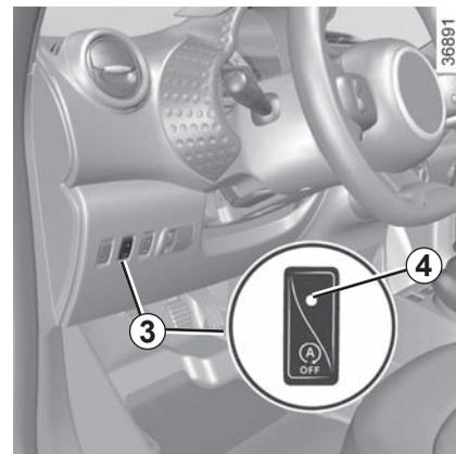
Uma nova pressão reativa o sistema. O testemunho integrado **2** apaga-se ou, consoante o veículo, apaga-se o testemunho integrado **4**.
