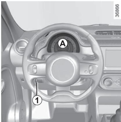
**Quadro della strumentazione A:** si illumina all'inserimento del contatto.
