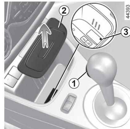
Se la leva è bloccata su **P**, può comunque essere rilasciata manualmente anche se si sta premendo il pedale del freno e il pulsante di sbloccaggio **1**. A tale scopo, staccare il tappetino **2** nella parte inferiore del vano portaoggetti per accedere alla leva di rilascio **3**. Successivamente, alzare la leva **3** e premere contemporaneamente il pulsante di sbloccaggio **1** sulla leva.
