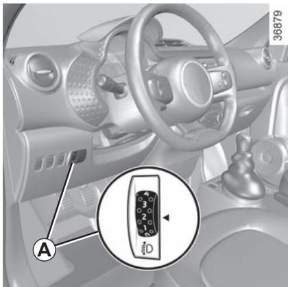
Il comando **A** è utilizzato per regolare l'altezza dei fari in funzione del carico.
