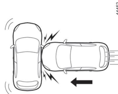
**En choc latéral** avec un autre véhicule de catégorie équivalente ou supérieure et à une vitesse d'impact égale ou supérieure à **50 km/h**.
