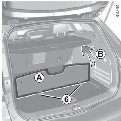
Pour replacer la partie **A** en position plancher, procédez dans le sens inverse.
