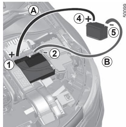
Fixez le câble positif **A** sur le **support 1** (+) situé sous le cache du boîtier 3, puis sur la **borne 4** (+) de la batterie fournissant le courant.
