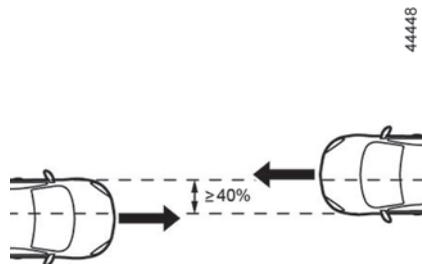
**En choc frontal** avec un autre véhicule de catégorie équivalente ou supérieure, sur un recouvrement égal ou supérieur à 40%, les vitesses de deux véhicules étant égales ou supérieures à **40 km/h**.
