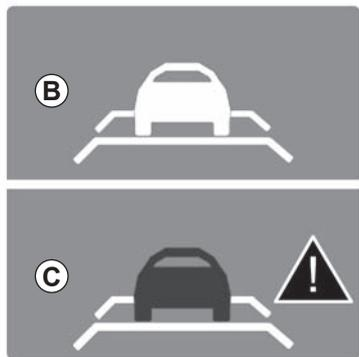
Dans certaines situations (arrivée sur un véhicule roulant beaucoup moins vite, changement de voie rapide des véhicules vous précédant...), le système peut ne pas avoir le temps de réagir et pourra émettre un signal sonore associé à l'alerte **B** lors de situation nécessitant l'attention du conducteur, ou à l'alerte **C** lors de situation nécessitant une action immédiate du conducteur.
