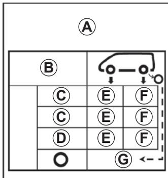
**B** : dimension des pneumatiques équipant le véhicule.
