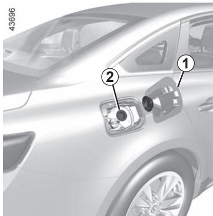
Véhicule déverrouillé, pour ouvrir le portillon **1**, appuyez sur la zone **A**. puis relâchez. Le portillon **1** s'entre-ouvre. Le clapet **2** est intégré au conduit de remplissage.
