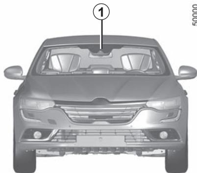
L'alerte de survitesse avec reconnaissance des panneaux de signalisation informe le conducteur du dépassement de la limitation de vitesse sur la portion de route sur laquelle il se trouve.
