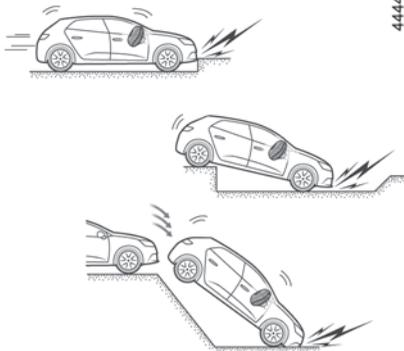
**Dans les exemples de cas suivants, les prétensionneurs ou les airbags sont susceptibles d'être déclenchés :**
