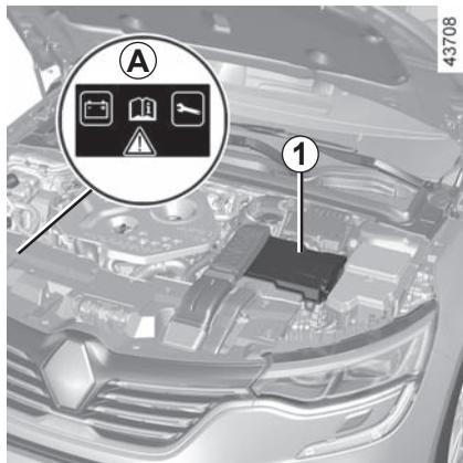
Suivant véhicule, la batterie **1** est positionnée dans le compartiment moteur ou sous le plancher du coffre.
