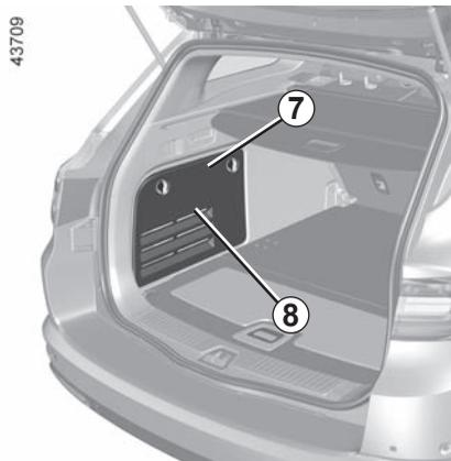
Suivant véhicule, pour les véhicules équipés d'un caisson de basse, ce dernier est situé derrière le portillon 8 du rangement 7.
