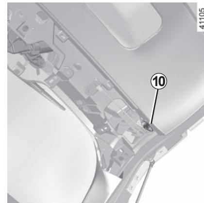
Tournez le porte-lampe 10 dans le sens inverse des aiguilles d'une montre et changez la lampe.
