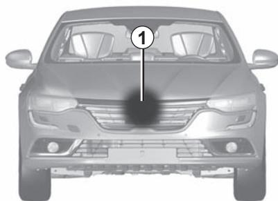
À partir des informations provenant du radar **1**, cette fonction avertit le conducteur de l'intervalle de temps qui le sépare du véhicule qui le précède afin de respecter les distances de sécurité entre les 2 véhicules.
