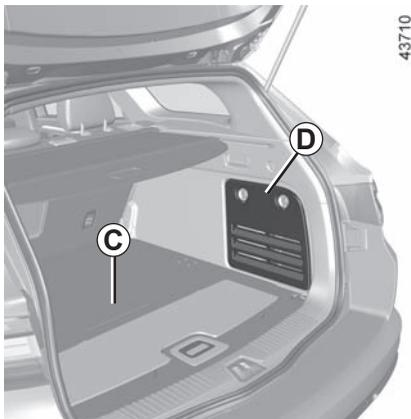
En cas de crevaison, utilisez le kit situé suivant véhicule sous le tapis de coffre **C** ou dans le rangement **D** à droite.
