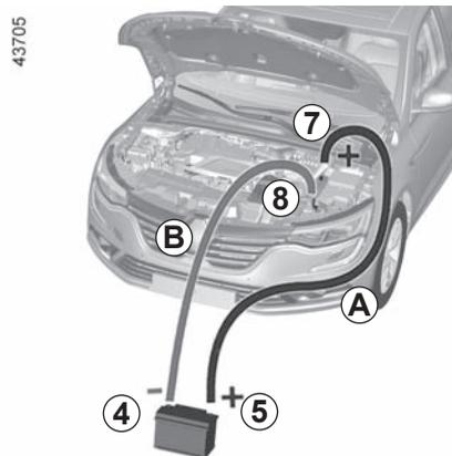
Fixez le câble positif **A** sur le **bornier 7 (+)**, puis sur la **borne 5 (+)** de la batterie fournissant le courant.
