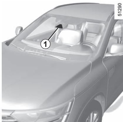
Utilizando as informações do radar **1**, esta função informa o condutor sobre o intervalo de tempo que o separa do veículo que segue à sua frente, de modo a que seja possível manter uma distância de travagem segura entre os 2 veículos.
