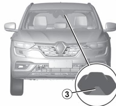
Le système **B** utilise le capteur de la caméra-radar **3**.
