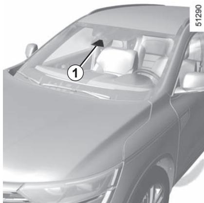
À partir des informations provenant du radar **1**, cette fonction avertit le conducteur de l'intervalle de temps qui le sépare du véhicule qui le précède afin de respecter les distances de sécurité entre les 2 véhicules.
