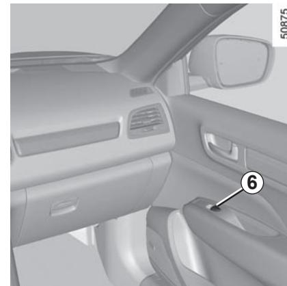
Vermeiden Sie das Abstützen von Gegenständen auf einer halbgeöffneten Fensterscheibe: Gefahr einer Beschädigung des Fensterhebers.
