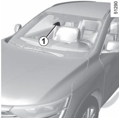
Diese Funktion nutzt Informationen des Radars **1** und informiert den Fahrer über den zeitlichen Abstand zwischen dem eigenen und dem vorausfahrenden Fahrzeug, sodass ein sicherer Bremsabstand zwischen den beiden Fahrzeugen gehalten werden kann.
