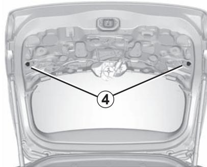
Drehen Sie den Lampenträger **4** entgegen dem Uhrzeigersinn und wechseln Sie die Lampe.
