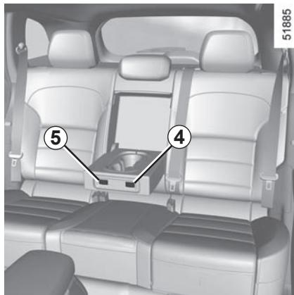
Je nach Fahrzeug befindet sich nach dem Absenken der Rücksitzarmlehne ein Bedienelement für die Rücksitzheizung auf der hinteren Armlehne.
