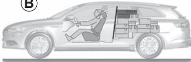
Je nach Fahrzeug ist die Verwendung sinnvoll, um den Gepäckraum vom Fahrgastraum abzutrennen (Transport von Tieren oder Gepäckstücken).
