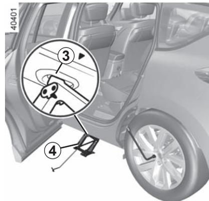
Coloque o macaco **4** horizontalmente. É **essencial** colocar a cabeça do macaco no suporte da chapa **3**.
