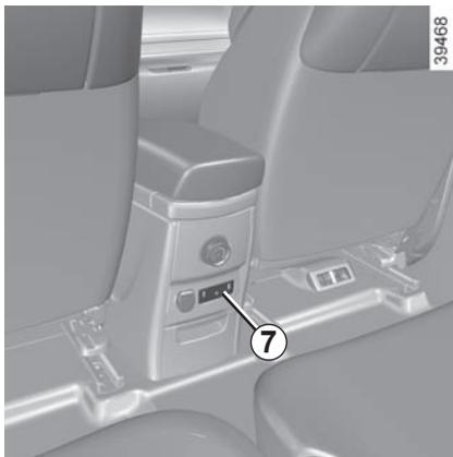
As tomadas USB permitem, igualmente, recarregar acessórios homologados pelos Serviços técnicos da marca, cuja potência não exceda 12 Watts (tensão 5 V) por tomada.
