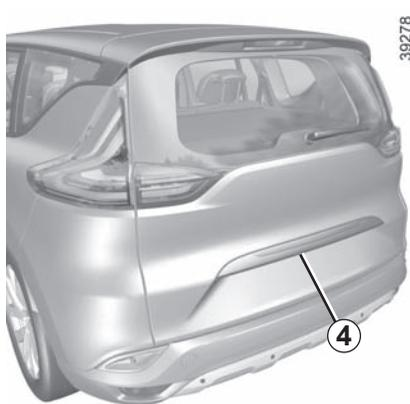
**Nota:** o sistema «mãos livres» poderá ser afetado por dificuldades temporárias se um dos sensores integrados no interior do puxador da porta estiver obstruído (por sujidade, lama, neve, sal espalhado, etc.). Limpe os sensores. Dirija-se a um representante da marca, se o problema subsistir.
