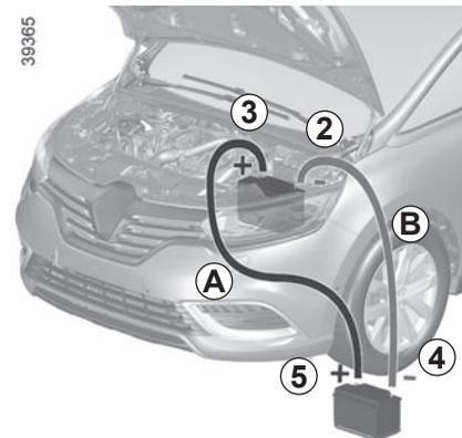
Fixe o cabo positivo **A** ao **suporte 3 (+)** situado sob a tampa da caixa **1** e, em seguida, ao **borne 5 (+)** da bateria que fornece a corrente.
