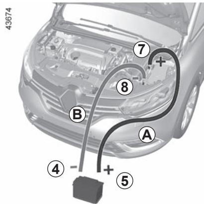
Ligue o cabo positivo **A** ao **terminal 7 (+)** e, em seguida, ao **terminal 5 (+)** da bateria que fornece a corrente.
