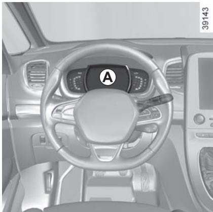
**Quadro de instrumentos A:** Ilumina-se ao abrir a porta do condutor.
