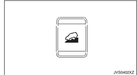
Si es necesario frenar adicionalmente el vehículo al descender por pendientes pronunciadas, active el sistema de control de descenso poniendo el botón de control de descenso a la posición ON.
