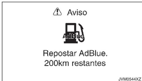
Este aviso proporciona una estimación de la distancia [de 0 a 1.000 km (De 0 a 621 millas)] que se puede conducir antes de que se vacíe el nivel del depósito de AdBlue®. Este mensaje se mostrará de forma continua; no se puede eliminar de la pantalla.
