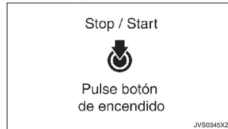
Se muestra la información y suena una señal acústica para recordar al conductor que debe poner el interruptor de encendido en la posición "OFF" para evitar la descarga de la batería.
