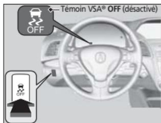
Ce bouton se trouve sur le panneau des commandes côté conducteur. Pour activer et désactiver le système VSA®, maintenir le bouton enfoncé jusqu'à l'obtention d'un signal sonore.
