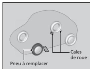
5. Placer une cale de roue ou une pierre en avant et en arrière de la roue en diagonale du pneu à plat.
