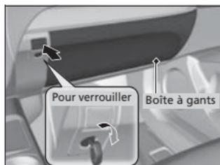
Appuyer sur le bouton pour ouvrir la boîte à gants. Il est possible de verrouiller la boîte à gants avec la clé incorporée.
