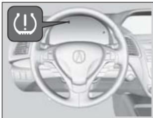
Surveille la pression de gonflage des pneus pendant la conduite. Si la pression de gonflage des pneus du véhicule s'abaisse considérablement, le témoin de basse pression de gonflage des pneus/TPMS s'allume et un message apparaît sur l'affichage multifonctions.
