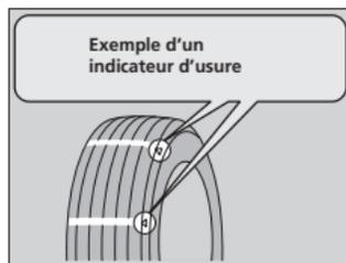
La rainure où l'indicateur d'usure est situé est 1,6 mm (1/16 po) plus étroite qu'ailleurs sur le pneu. Si la bande de roulement est usée de manière à exposer l'indicateur, remplacer le pneu. **Les pneus usés ont une mauvaise traction sur les routes humides.**
