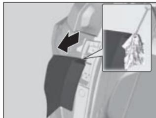
1. Retirer le couvercle en soulevant le bord à l'aide d'un tournevis à lame plate.
