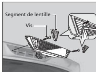
1. Retirer le segment de lentille en soulevant le bord à l'aide d'un tournevis à lame plate.
