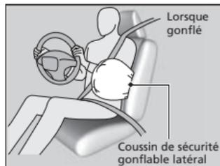
Lorsque les capteurs détectent un choc latéral d'intensité modérée à grave, l'unité de contrôle envoie un signal de déploiement immédiat au coussin de sécurité gonflable latéral situé du côté du choc.
