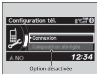
Certaines fonctions manuelles sont désactivées ou non-opérationnelles lorsque le véhicule est en mouvement. Les options estompées ne peuvent être sélectionnées jusqu'à ce que le véhicule soit arrêté.
