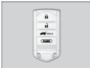
Utiliser la télécommande d'accès sans clé pour démarrer et éteindre le moteur et pour verrouiller et déverrouiller toutes les portières et le hayon. Le système d'accès sans clé peut aussi être utilisé pour verrouiller et déverrouiller les portières ainsi que le hayon.
