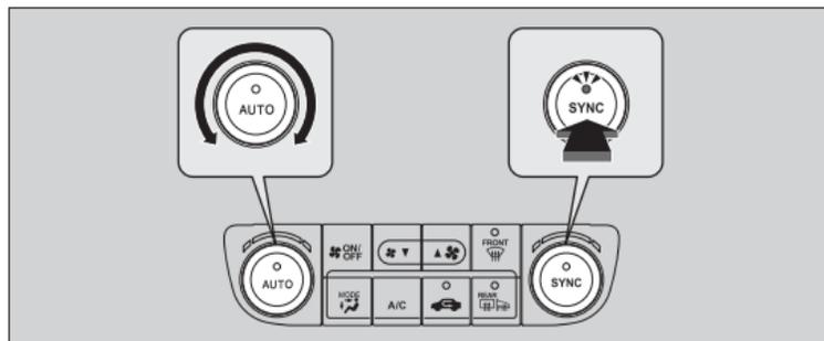
En mode synchronisé, la température peut être réglée pour être synchronisée du côté conducteur et du côté passager.
