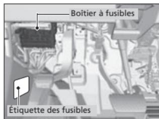
Les emplacements des fusibles apparaissent sur l'étiquette posée sur le panneau latéral. Trouver le fusible visé en utilisant le numéro de fusible et le numéro d'étiquette.
