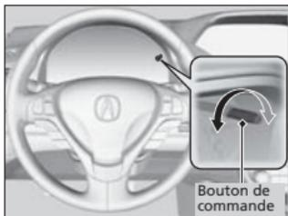
Lorsque le mode d'alimentation est à MARCHE, utiliser le bouton de commande de luminosité pour régler l'intensité lumineuse du tableau de bord.
