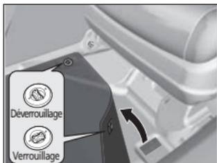
Les tapis de plancher avant se fixent sur les ancrages de plancher qui empêchent les tapis de glisser vers l'avant. Pour retirer un tapis afin de le nettoyer, tourner les boutons d'ancrage à la position déverrouillée. Réinstaller les tapis suite au lavage du véhicule et tourner les boutons d'ancrage à la position verrouillée.
