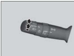
La commande de fonctionnement automatique des phares peut être utilisée lorsque le mode d'alimentation est à MARCHÉ.
