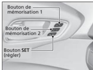
1. Régler le mode d'alimentation à MARCHE. Régler le siège conducteur et les rétroviseurs latéraux aux positions désirées.
