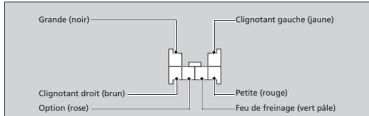
Le connecteur des feux de remorque est situé derrière le panneau latéral gauche dans le compartiment à bagages. L'usage de chaque broche et le code de couleur du câblage sont illustrés dans l'image.
