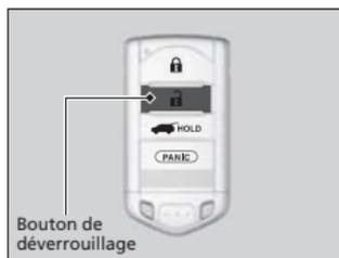
**Pour ouvrir :** Appuyer sur le bouton de DÉVERROUILLAGE deux fois en dix secondes et le garder enfoncé la deuxième fois. Si les glaces arrêtent à mi-chemin, répéter la procédure.
