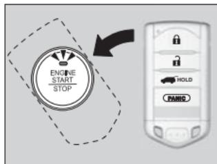
1. Toucher le centre du bouton **ENGINE START/STOP** (mise en marche/arrêt du moteur) avec le logo **A** sur la télécommande d'accès sans clé pendant que le témoin clignote sur le bouton **ENGINE START/STOP**. Les boutons sur la télécommande d'accès sans clé doivent vous faire face.
