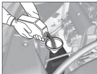
2. Si le niveau du liquide de refroidissement est inférieur au repère **MIN**, ajouter le liquide spécifié jusqu'à ce qu'il atteigne le repère **MAX**.
