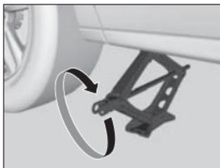
2. Tourner le support du bout (tel que montré sur l'image) vers la droite jusqu'à ce que le dessus du cric touche le point de levage.
