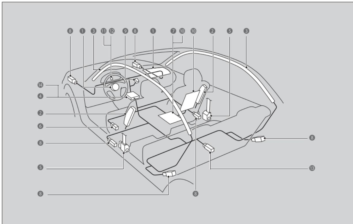
Les coussins de sécurité gonflables avant, les coussins de sécurité gonflables latéraux et les rideaux de sécurité gonflables latéraux se déploient en fonction de l'angle du choc et de sa gravité. Les deux rideaux de sécurité gonflables latéraux se déploient lors d'un capotage. Le système de coussins de sécurité gonflables inclut :
