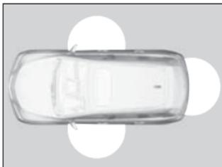
Lorsqu'on transporte la télécommande d'accès sans clé avec soi, on peut verrouiller/déverrouiller les portières et le hayon.
