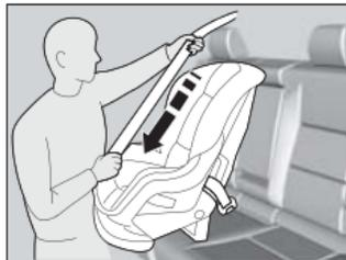
3. Tirer la partie épaulière de la ceinture lentement et complètement jusqu'à ce qu'elle s'arrête. Cela active le mécanisme de blocage.
