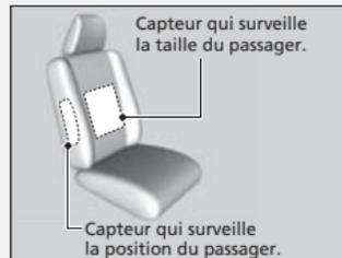
Les capteurs qui surveillent la taille et la position du corps du passager avant peuvent ne pas fonctionner dans les situations suivantes :
