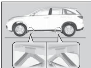
1. Placer le cric sous le point de levage le plus près du pneu à remplacer.
