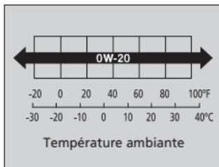
Utiliser une huile moteur Acura authentique ou une huile moteur commerciale avec la bonne viscosité en fonction de la température ambiante, conformément au tableau suivant.
