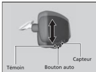
En situation de conduite de nuit, le rétroviseur à atténuation automatique réduit l'éblouissement des phares des véhicules suivant derrière. Appuyer sur le bouton Auto pour activer et désactiver cette fonction. Lorsque cette fonction est activée, le témoin Auto s'allume.
