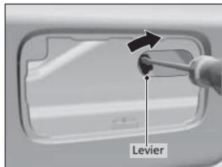
1. Utiliser un tournevis à lame plate et retirer le couvercle du côté intérieur du hayon.
