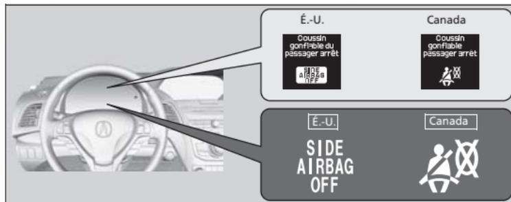
Ce témoin s'allume si le coussin de sécurité gonflable latéral du passager a été désactivé en raison de la présence d'un passager trop petit pour occuper le siège avant, qui adopte une posture relâchée ou n'est pas assis en position droite, ou qui se penche dans la voie de déploiement du coussin de sécurité gonflable.
