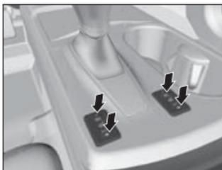
Au réglage **HI** (haut), le chauffe-siège s'allume et s'éteint en alternance.
