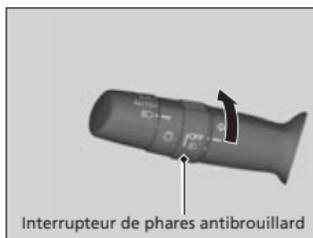
Les feux de croisement étant allumés, tourner l'interrupteur de phares antibrouillard pour utiliser les phares antibrouillard.
