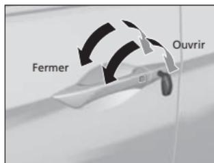
**Pour ouvrir :** Déverrouiller la portière du conducteur avec la clé. Dans les dix secondes suivant le retour de la clé à la position centrale, tourner la clé dans le sens du déverrouillage et la maintenir dans cette position.
