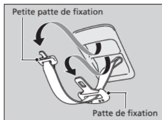
1. Sortir la petite patte de fixation de la ceinture de sécurité ainsi que la patte de fixation hors des encoches de retenue situées au plafond.
