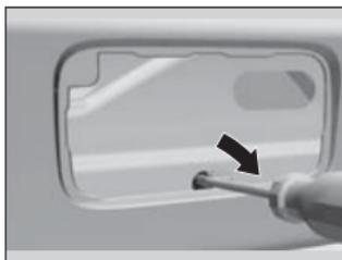
2. Pour ouvrir le hayon, pousser sur le hayon en poussant le levier vers le bas à l'aide du tournevis à lame plate.
