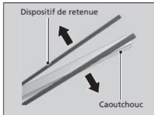
3. Retirer les dispositifs de retenue du balai d'essuie-glaces et les monter sur un nouveau balai en caoutchouc.
