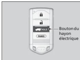
Appuyer sur le bouton du hayon électrique pendant plus qu'une seconde pour activer le système.
