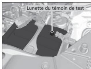
Vérifier l'état de la batterie chaque mois. Regarder dans la lunette du témoin de test et vérifier si les bornes présentent de la corrosion.
