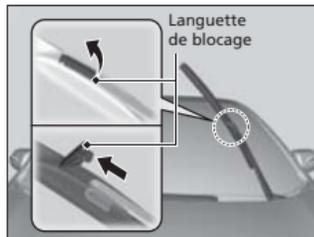
2. Déposer un chiffon sur la bordure de la languette de blocage. Relever la languette de blocage à l'aide d'un tournevis à lame plate.
