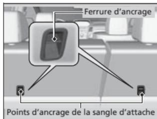
Les sièges latéraux arrière disposent de deux points d'ancrage à l'arrière des dossiers, et un autre se situe au plafond pour le siège arrière central. En vue d'une sécurité accrue, on peut utiliser la sangle d'attache d'un siège de sécurité pour enfant qui est installé à l'aide d'une ceinture de sécurité.
