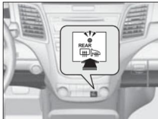
Le désembueur de lunette et les rétroviseurs latéraux chauffants s'éteignent automatiquement après un délai de 10 à 30 minutes, en fonction de la température extérieure. Cependant, si la température extérieure est de 0 °C ou en dessous, ils ne s'éteignent pas automatiquement.
