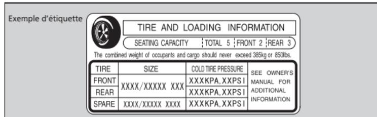
Cet exemple inclut le poids total de tous les occupants, des bagages, des accessoires et de la charge sur la flèche d'attelage si on tire une remorque.
