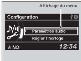
Utiliser le bouton sélecteur ou appuyer sur le bouton **SETUP** (configuration) pour accéder à certaines des fonctions audio.
