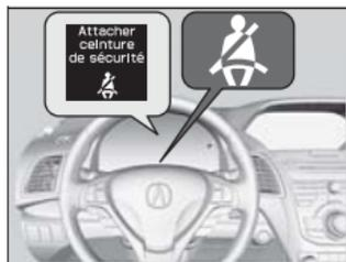
Le véhicule surveille l'utilisation des ceintures de sécurité avant. Si le mode d'alimentation passe à MARCHE avant que la ceinture de sécurité du conducteur ne soit bouclée, un signal sonore se fera entendre et le témoin clignotera. Si le conducteur ne boucle pas sa ceinture avant l'arrêt du signal sonore, le témoin restera allumé.
