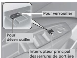
Appuyer sur l'interrupteur principal des serrures de portière conformément à l'illustration pour verrouiller ou déverrouiller toutes les portières et le hayon.
