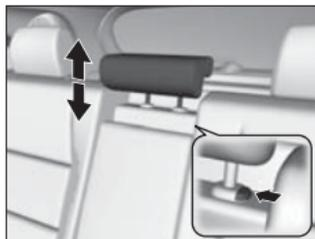
Un passager assis sur le siège arrière central doit régler la hauteur de son appuie-tête à une position appropriée avant que le véhicule ne commence à se déplacer.
