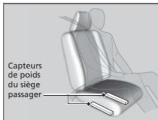
Le système avancé du coussin de sécurité gonflable avant du passager est muni de capteurs de poids.
