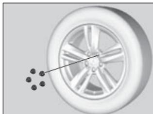
1. Enlever les écrous de roue et le pneu à plat.
