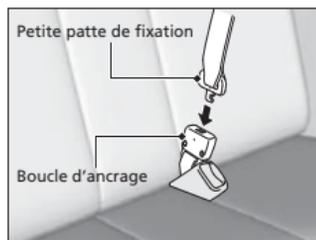
2. Aligner les marques triangulaires sur la petite patte de fixation et sur la boucle d'ancrage. S'assurer que la ceinture de sécurité n'est pas tordue. Attacher la ceinture à la boucle d'ancrage.
