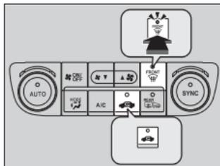
Le fait d'appuyer sur le bouton
