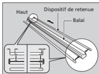
5. Retirer les dispositifs de retenue du balai en caoutchouc démonté, puis les installer sur un nouveau balai en caoutchouc.
