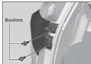
2. Utiliser un tournevis cruciforme pour enlever les boulons.
