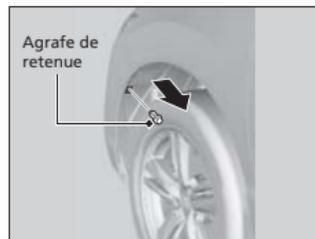
1. Tourner le volant de direction jusqu'au bout dans le sens opposé au phare antibrouillard à remplacer.
