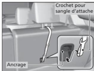
3. Soulever l'appui-tête à sa position la plus haute. Passer ensuite la sangle d'attache entre les tiges de l'appui-tête et fixer le crochet de la sangle d'attache dans l'ancrage.
