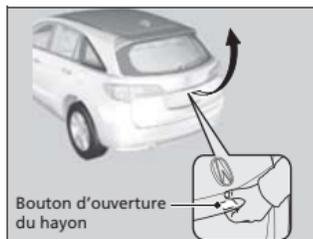
Lorsque toutes les portières sont déverrouillées, le hayon est aussi déverrouillé. Appuyer sur le bouton d'ouverture du hayon, et soulever le hayon pour l'ouvrir.
