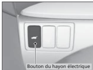
Maintenir enfoncé le bouton du hayon sur le tableau de bord pendant environ une seconde pour ouvrir ou fermer le hayon électrique. Un signal sonore se fait entendre et certains feux extérieurs clignotent.
