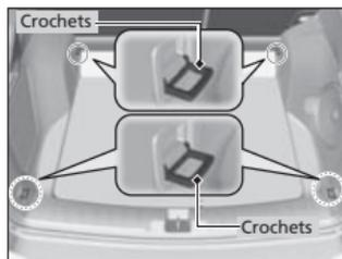
Utiliser les crochets de fixation des bagages situés sur le plancher pour retenir ceux-ci dans le compartiment à bagages.
