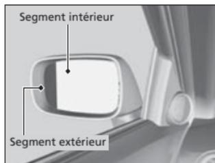
Le rétroviseur latéral du côté conducteur est constitué d'un segment intérieur et d'un segment extérieur.
