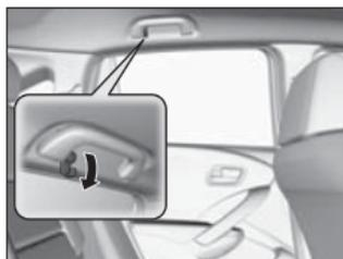
Il y a un crochet à vêtements sur la poignée de maintien de chaque côté du véhicule. Tirer sur le crochet vers le bas pour l'utiliser.
