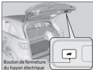
Appuyer sur le bouton sur le hayon pour fermer le hayon électrique.
