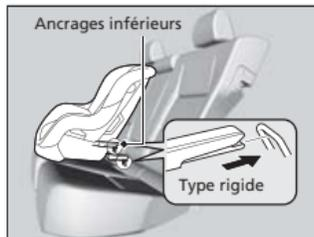
2. Mettre le siège de sécurité pour enfant sur le siège du véhicule, puis attacher le siège aux ancrages du bas conformément aux directives accompagnant le siège de sécurité pour enfant.
