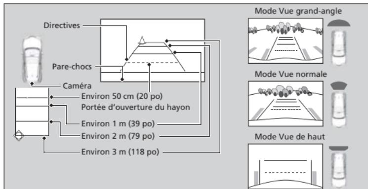
Il est possible de voir trois différents angles de caméra sur l'affichage de la vue arrière. Appuyer sur le bouton sélecteur pour changer l'angle.
