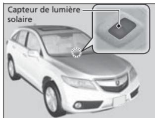
Le système de contrôle automatique de la température est muni d'un capteur de lumière solaire et d'un capteur de la température intérieure. Ne pas les recouvrir ou y renverser des liquides.
