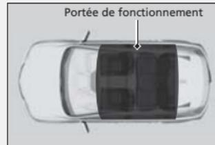
Le moteur peut être démarré lorsque la télécommande d'accès sans clé est dans le véhicule.
