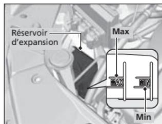
1. Vérifier le niveau du liquide de refroidissement dans le réservoir d'expansion.
