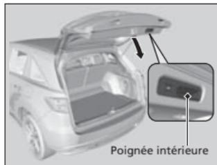
Pour fermer le hayon manuellement, saisir la poignée intérieure, tirer le hayon vers le bas, et pousser sur celui-ci de l'extérieur pour le fermer.
