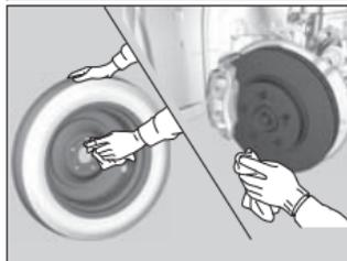
2. Essuyer les surfaces de montage de la roue avec un chiffon propre.
