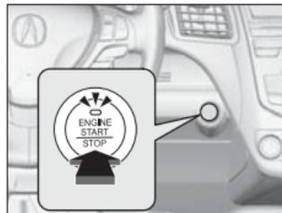
3. Appuyer sur le bouton **ENGINE START/STOP** (mise en marche/arrêt du moteur) sans appuyer sur la pédale d'accélérateur.
