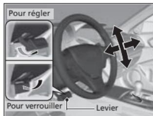
1. Relever le levier de réglage du volant de direction.
