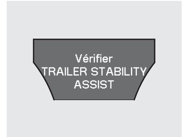
L'unité de contrôle surveille le circuit du système VSA et le système de freinage. Si le système de feu de freinage est défectueux, le système d'assistance à la stabilité de la remorque s'annule de lui-même et le message « Vérifier TRAILER STABILITY ASSIST » (assistance à la stabilité de remorque) apparaît sur l'affichage multifonctions.
