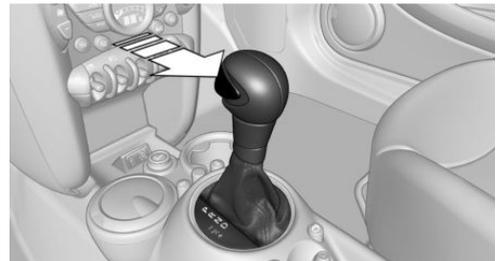
Un dispositif de blocage empêche un passage par erreur sur les positions du levier sélecteur R et P.
