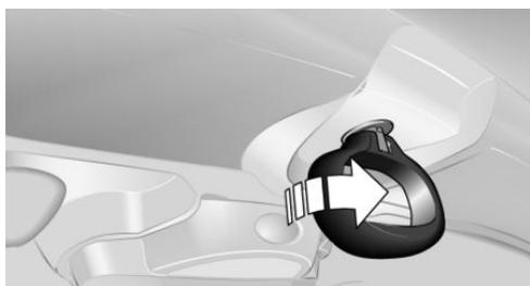
2. Par la poignée, pousser la capote déverrouillée vers le haut et l'ouvrir sur un espace d'environ de la largeur d'une main.
