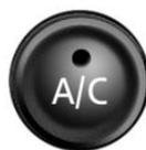
Lorsque la fonction de refroidissement est activée, l'air est réfrigéré, séché puis réchauffé suivant la température choisie.
