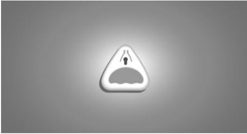
Tirer sur la poignée dans le compartiment à bagages. Le hayon se déverrouille.
