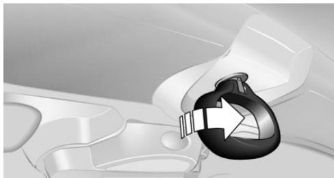
2. Par la poignée, pousser la capote déverrouillée vers le haut et l'ouvrir sur un espace d'environ de la largeur d'une main.
