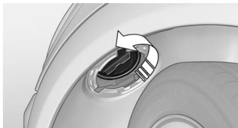
4. Tourner l'ampoule dans le sens antihoraire et la retirer.
