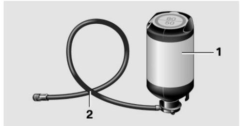
1 Bouteille de produit d'étanchéité et auto- collant avec limitation de vitesse
