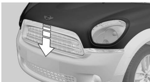
Fermer le capot moteur d'une hauteur d'env. 16 po./40 cm avec élan. Il doit s'enclencher avec un déclic nettement audible.
