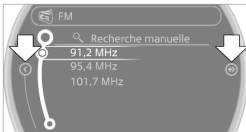
Les flèches blanches à gauche ou à droite montrent que d'autres tableaux peuvent être appelés.
