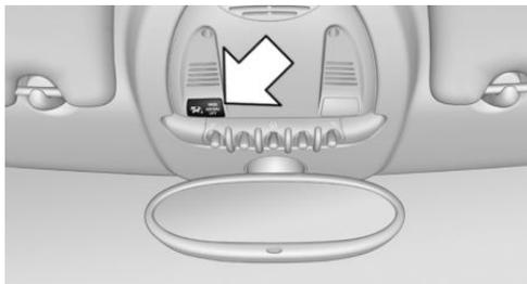
Le témoin des airbags du passager avant montre l'état de fonctionnement des airbags du passager avant.
