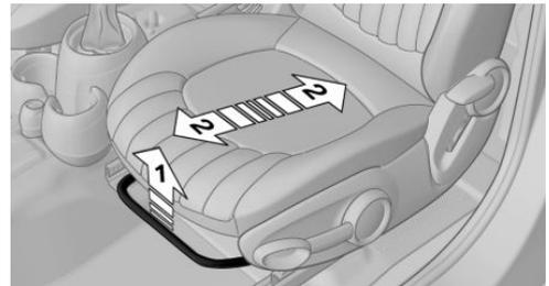
Tirer le levier, flèche 1, et pousser le siège sur la position souhaitée, flèches 2.
