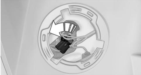
5. Pour installer l'ampoule neuve et remettre le cache, procéder dans l'ordre inverse.
