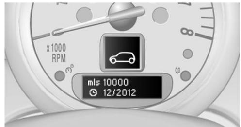
La distance restante à parcourir et la date pour la maintenance suivante sont indiquées brièvement, juste après le démarrage du moteur ou après la mise du contact.
