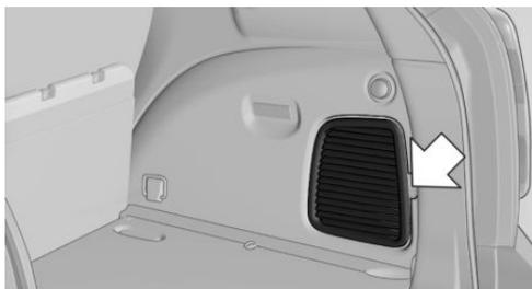
4. Décrocher le dispositif de déverrouillage de secours de la trappe du réservoir, voir page 228, et le pousser de côté avec la mousse.
