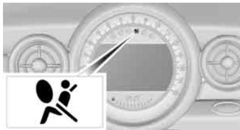
À partir de la transmission radio, voir page 66, le voyant d'alerte s'allume brièvement pour indiquer que tout le système de coussins gonflables et les tendeurs de ceintures fonctionnent.
