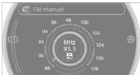
Mise en mémoire de la station : appuyer sur le levier de commande de la MINI.
