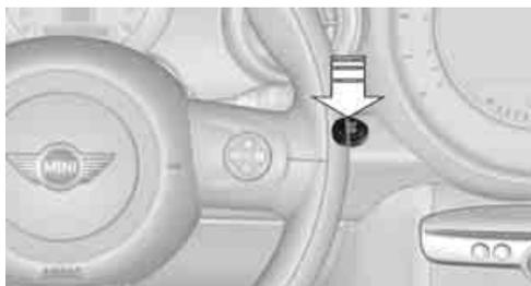
Appuyer sur le bouton Start/Stop pour activer et couper la transmission radio ou allumer/couper le contact. Ne pas enfoncer la pédale de frein ou d'embrayage en même temps.
