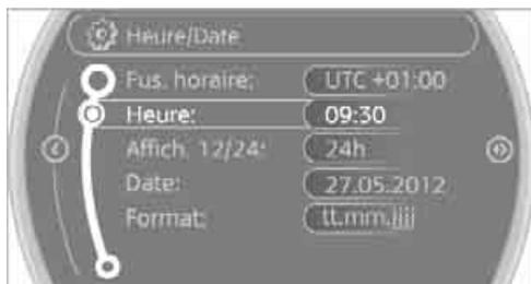
5. Tourner le levier de commande de la MINI pour régler l'heure et appuyer sur le levier de commande de la MINI.
