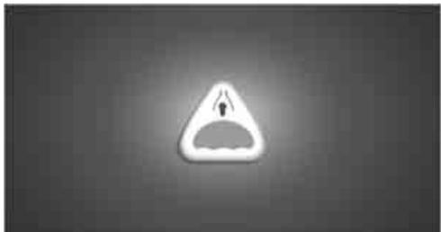
Tirer sur la poignée dans le coffre. Le hayon est déverrouillé.
