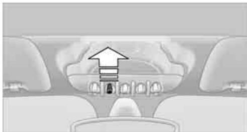
3. Appuyer sur l'interrupteur vers l'arrière pour ouvrir la capote. Les vitres s'ouvrent pendant cette opération.
