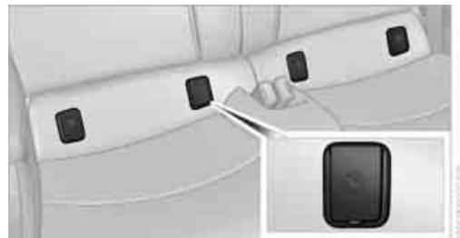
Les points d'ancrage inférieurs pour fixation de siège d'enfant LATCH se trouvent derrière les caches protecteurs indiqués.
