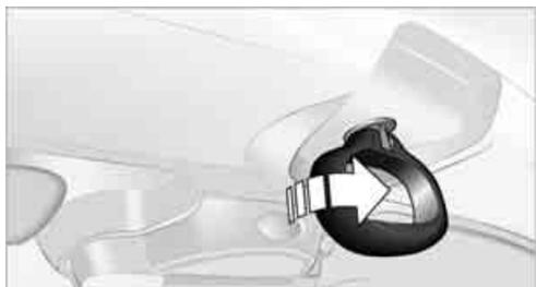
2. Utiliser la poignée pour pousser la capote déverrouillée vers le haut et l'ouvrir d'environ 15 cm/6 pouces.
