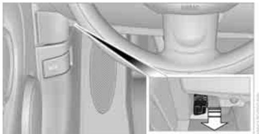
On peut vérifier les principaux composants des émissions à l'aide d'un dispositif par le connecteur de diagnostic embarqué.
