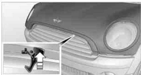
**!** Afin d'éviter tout dégât, s'assurer que les bras d'essuie-glace sont bien appuyés sur le pare-brise avant d'ouvrir le capot. ◀
