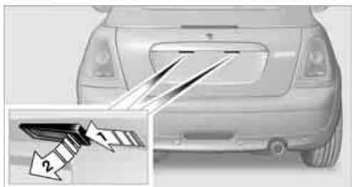
1. À l'aide d'un tournevis, enfoncer le feu vers la gauche dans la languette du logement du feu, flèche 1.
