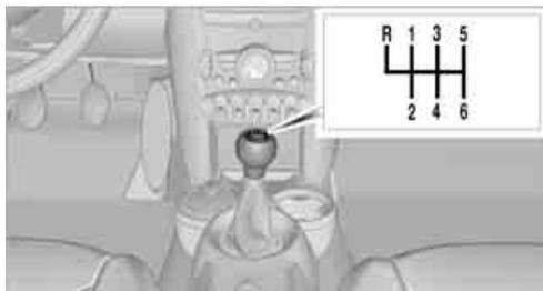
**⚠** Pousser le levier de changement de vitesse vers la droite en passant la 5e ou la 6e pour empêcher de passer par erreur en 3e ou en 4e et d'endommager le moteur. ◀
