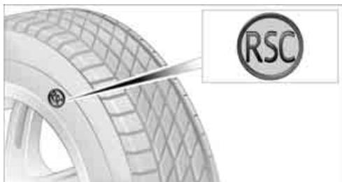
Les pneumatiques permettant de rouler à plat comportent un symbole circulaire contenant les lettres RSC sur la bande de roulement.
