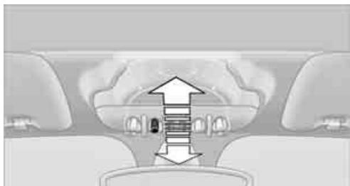
Mise en marche et arrêt de l'éclairage intérieur. Appuyer sur l'interrupteur.
