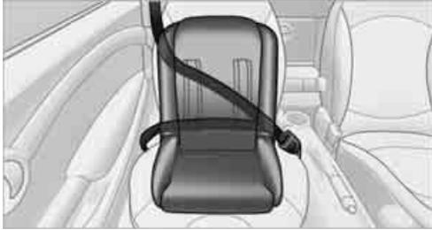
La ceinture de sécurité du passager avant est verrouillable pour permettre la fixation et l'arrimage d'un système de retenue pour enfant.
