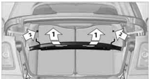
2. Tirer le cache-bagages à enrouleur vers l'arrière en le sortant des supports inférieurs et le faire pivoter vers le haut, voir les flèches 1.
