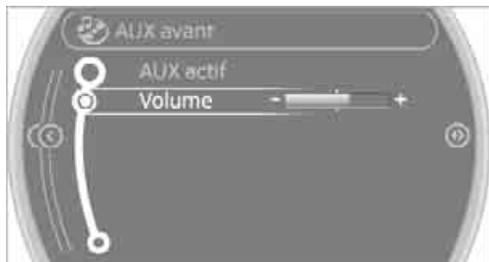
5. Tourner le levier de commande de la MINI pour régler le volume voulu, puis appuyer sur le levier.
