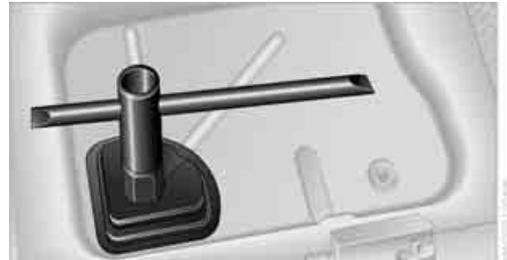
3. Visser la poignée de levage de l'outillage de bord du véhicule sur le filetage.
