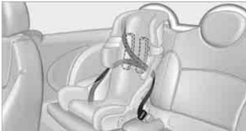
Les enrouleurs de toutes les ceintures de sécurité arrière et de la ceinture de sécurité du passager avant sont verrouillables pour permettre la fixation et l'arrimage d'un système de retenue pour enfant.
