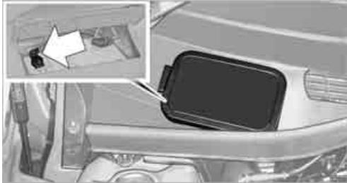
2. Retirer les languettes à gauche et à droite du cache de la borne positive, flèches 1, et soulever le cache, flèche 2.
