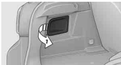
4. Déverrouiller les éléments de fixation en les tournant, flèche 1.
