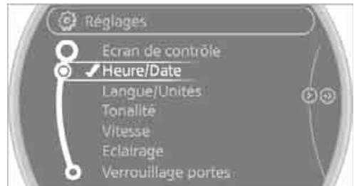
4. Tourner le levier de commande de la MINI jusqu'à ce que "Heure:" soit sélectionné et appuyer sur le levier.
