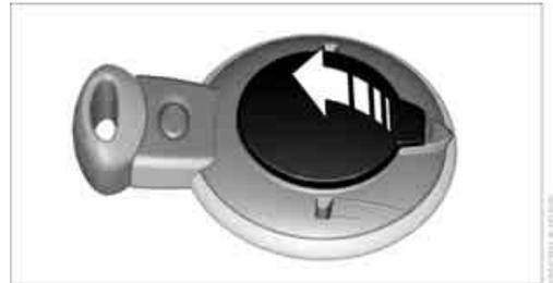
2. Insérer la pile neuve avec le côté plus face dessus.
