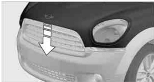
Fermer le capot d'une hauteur d'environ 40 cm / 16 pouces, avec un élan. Il faut bien l'entendre s'enclencher.
