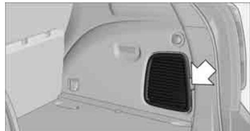
4. Ouvrir le mécanisme de déverrouillage de secours de la trappe de réservoir, voir page 212, puis le pousser sur le côté avec l'insert en mousse. Vérifier que le mécanisme de déverrouillage de secours n'est pas endommagé.
