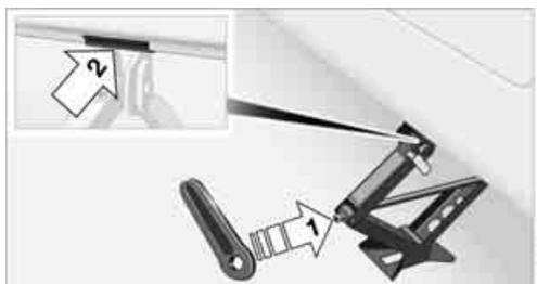
3. Tout en montant le cric, placer la tête du cric sur le point de levage, flèche 2.
