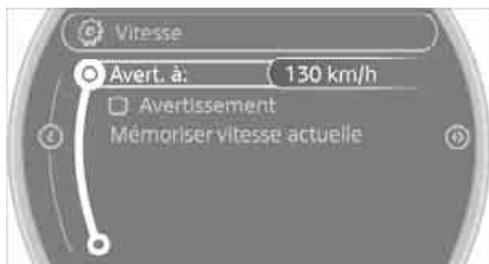
4. Tourner le levier de commande de la MINI pour régler la limite.
