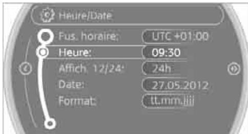
4. Tourner le levier de commande de la MINI pour régler l'heure et appuyer sur le levier de commande de la MINI.
