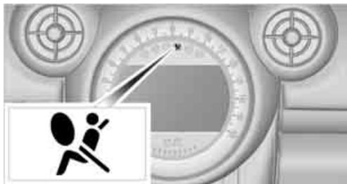
À partir de la transmission radio, voir page 56, le voyant d'alerte s'allume brièvement pour indiquer que tout le système de coussins gonflables et les tendeurs de ceintures fonctionnent.
