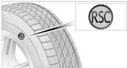
Les pneumatiques permettant de rouler à plat comportent un symbole circulaire contenant les lettres RSC sur la bande de roulement. Les pneumatiques permettant de rouler à plat comprennent un pneu autoportant et une jante spéciale. Grâce au renfort des flancs, la conduite demeure possible jusqu'à certaines limites en cas de crevaison.
