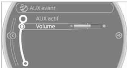
5. Tourner le levier de commande de la MINI pour régler le volume voulu, puis appuyer sur le levier.
