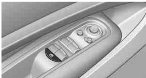
L'interrupteur de sécurité interdit l'ouverture et la fermeture des vitres arrière au moyen des interrupteurs de l'arrière, par des enfants, par exemple.
