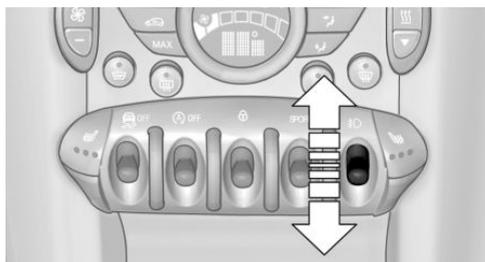
Allumer les projecteurs antibrouillard : appuyer sur le commutateur.
