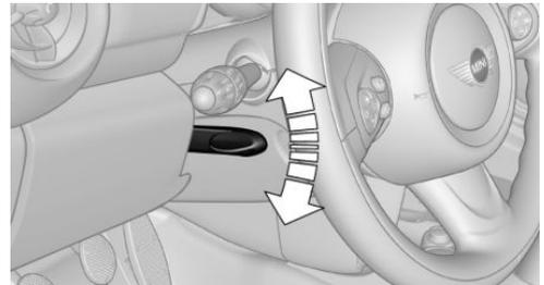
2. Adapter longitudinalement et en hauteur la position du volant à la position assise.
