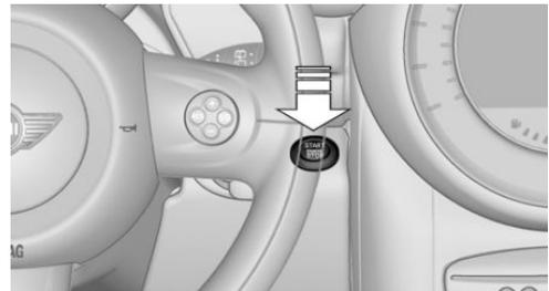
Une pression sur le bouton Start/Stop permet de mettre et de couper le contact ainsi que de mettre le moteur en marche.
