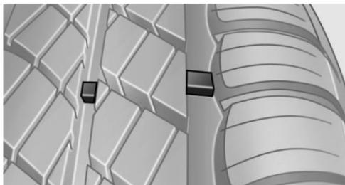
Des témoins d'usure sont répartis sur l'ensemble du pneu et indiqués par TWI, Tread Wear Indicator (indicateur d'usure). Si le profil des pneus est descendu jusqu'au témoins d'usure, une profondeur de sculpture de 0,063 po / 1,6 mm n'est pas obtenue.
