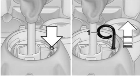
4. Placer le crochet extracteur 1 dans la boucle côté passager.
