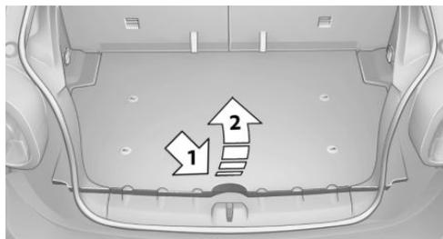
Avant de fermer le hayon, reposer le plancher de chargement sur le plancher du compartiment à bagages.
