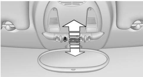
Allumer / éteindre l'éclairage intérieur : appuyer sur le commutateur.
