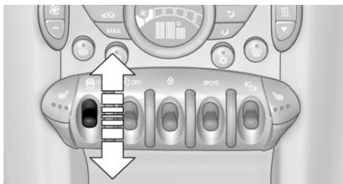
Appuyer sur le commutateur jusqu'à ce que le témoin DSC OFF s'allume sur le compteur de vitesse et que TRACTION s'affiche sur le compte-tours. Le contrôle dynamique de stabilité DSC est désactivé et le contrôle dynamique de traction DTC est activé.
