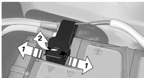
3. Brancher l'une des pinces crocodiles du câble positif de dépannage sur le pôle positif de la batterie ou sur le point de reprise correspondant pour dépannage du véhicule donneur de courant.
