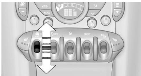
Appuyer sur le commutateur jusqu'à ce que le témoin DSC OFF s'allume sur le compteur de vitesse et que DSC OFF s'affiche sur le compte-tours. Le DSC est désactivé. Les interventions de stabilisation et d'optimisation de la traction ne sont plus exécutées.
