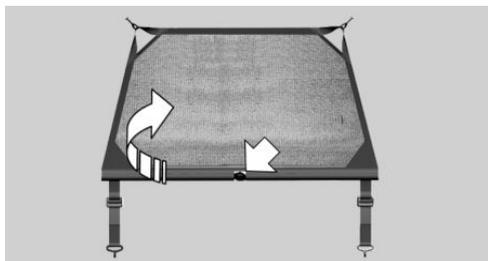
Pour le replier, appuyer sur le bouton de déverrouillage, flèche.
