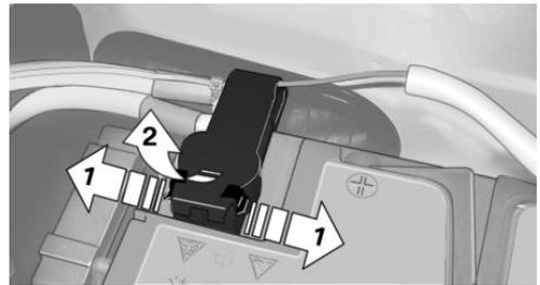
3. Brancher l'une des pinces crocodiles du câble positif de dépannage sur le pôle positif de la batterie ou sur le point de reprise correspondant pour dépannage du véhicule donneur de courant.
