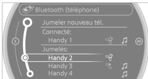
Les fonctions affectées avant le déjumelage du téléphone portable sont réaffectées à l'appareil lors de la connexion ultérieure. En cas de téléphone portable déjà connecté, ces fonctions sont désactivées si nécessaire.
