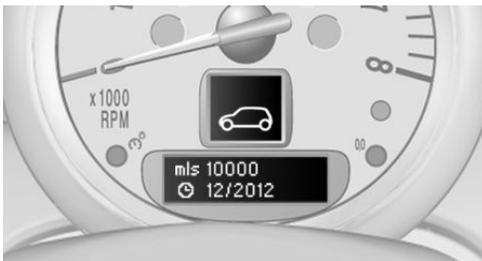
La distance restante à parcourir et la date pour la maintenance suivante sont indiquées brièvement, juste après le démarrage du moteur ou après la mise du contact.
