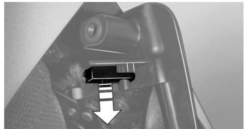
4. Desserrer la deuxième vis, flèche, avec la clé Allen pour déverrouiller la capote.
