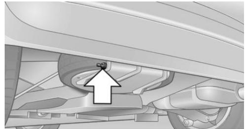
Un prolongateur de valve permettant de contrôler la pression de gonflage, se trouve derrière le bouclier.
