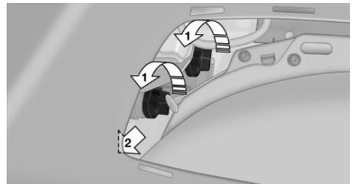
3. Pour installer l'ampoule neuve et remettre le cache, procéder dans l'ordre inverse.
