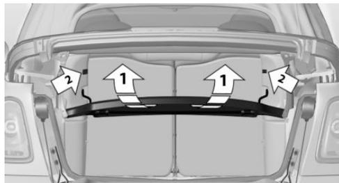
2. Retirer le cache du compartiment à bagages des supports inférieurs par l'arrière et le faire basculer vers le haut, voir flèche 1.
