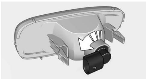
1. Retirer le support de l'ampoule en tournant dans le sens antihoraire, flèche.
