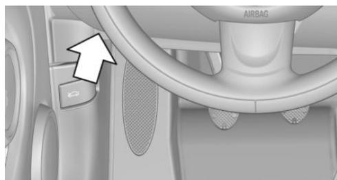
Les composants qui sont déterminants pour la composition des émissions peuvent être contrôlés avec un appareil par l'intermédiaire de la prise OBD.
