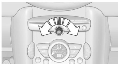
Tourner le bouton jusqu'à l'obtention du volume sonore désiré. Le réglage est mémorisé pour la télécommande actuellement utilisée.
