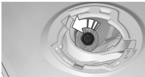
5. Pour installer l'ampoule neuve et remettre les caches, procéder dans l'ordre inverse.
