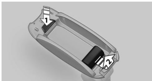
2. Brancher l'adaptateur snap-in à l'avant, flèche 1, puis appuyer vers le bas, flèche 2, jusqu'à ce qu'il s'enclenche.
