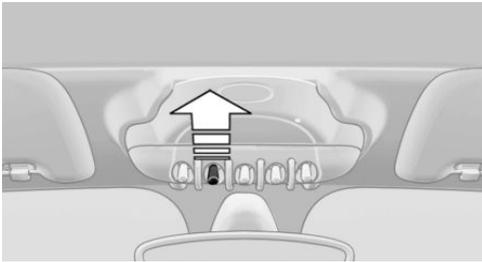
3. Appuyer le commutateur vers l'arrière pour ouvrir la capote. Les vitres s'ouvrent lors de cette procédure.
