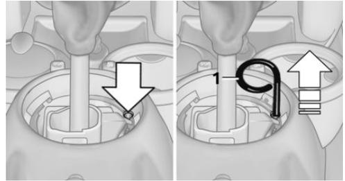
4. Placer le crochet extracteur 1 contenu dans l'outillage de bord dans la boucle côté passager.
