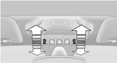
Allumer l'éclairage intérieur : appuyer le commutateur vers l'arrière.
