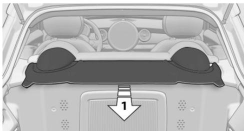
Tirer le cache vers l'arrière pour le sortir des fixations, flèche 1.
