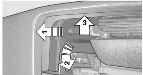
3. Retirer le capteur du cache, flèche, et le poser sur la garniture latérale intérieure.
