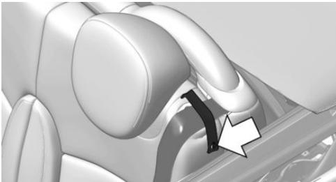
Lorsque les ceintures de sécurité sont bouclées sur les sièges arrière, veiller à ce que la boucle de guidage, flèche, soit fermée.
