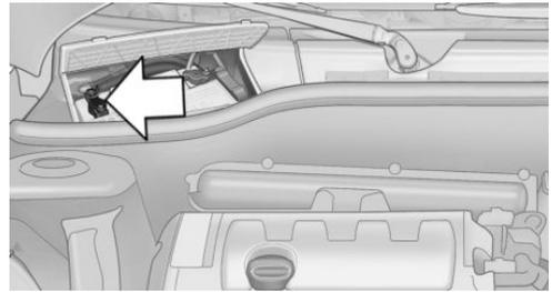
2. Détacher les attaches du cache du pôle positif à gauche et à droite, flèches 1, et ouvrir le cache vers le haut, flèche 2.
