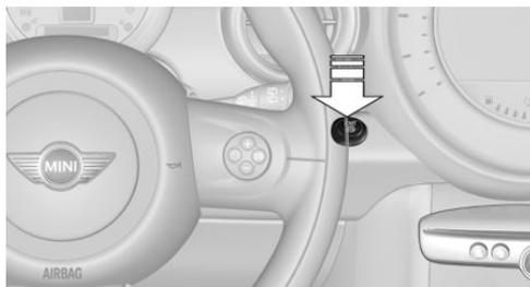
Une pression sur le bouton Start/Stop permet de mettre et de couper le contact ainsi que de mettre le moteur en marche.
