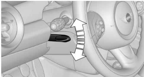
2. Adapter longitudinalement et en hauteur la position du volant à la position assise.
