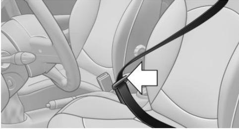
La boucle doit s'enclencher de façon franche et audible.
