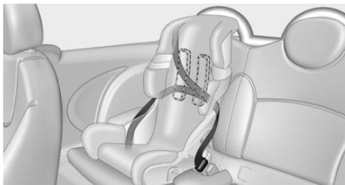
Toutes les ceintures de sécurité arrière et la ceinture de sécurité du passager avant peuvent être bloquées de sorte à ne plus pouvoir être tirées afin de fixer les systèmes de retenue pour enfant.
