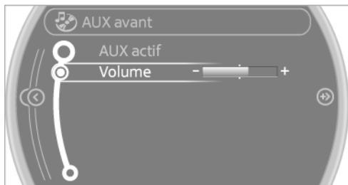
5. Tourner le joystick MINI jusqu'à ce que soit le volume sonore souhaité soit réglé et appuyer sur le joystick MINI.
