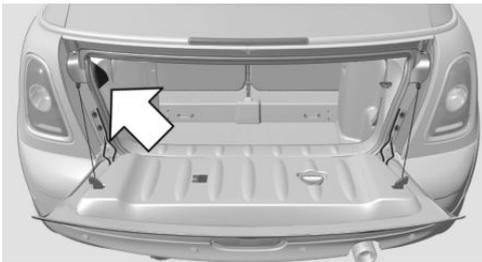
2. Tirer sur le bouton vert portant le symbole d'une pompe à essence. La trappe du réservoir est déverrouillée.
