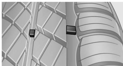
Des témoins d'usure sont répartis sur l'ensemble du pneu et indiqués par TWI, Tread Wear Indicator (indicateur d'usure). Si le profil des pneus est descendu jusqu'aux témoins d'usure, une profondeur de sculpture de 0,063 po / 1,6 mm n'est pas obtenue.
