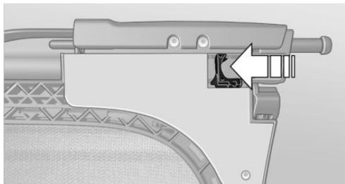
Pousser le levier de déverrouillage au milieu du coupe-vent et replier les deux moitiés.
