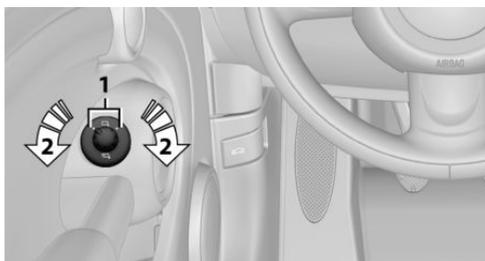
2. Pour régler le rétroviseur, faire basculer le bouton dans la direction souhaitée vers l'avant, l'arrière, la gauche ou la droite.
