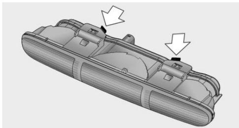
1. Appuyer sur les clips de serrage, flèches, et retirer le support d'ampoule.
