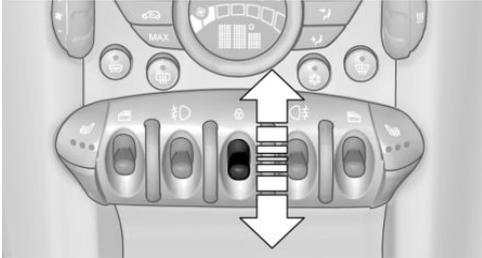
Le commutateur permet de déverrouiller ou de verrouiller les portes et le hayon lorsque les portes sont fermées mais sans sécurité antivol. La trappe du réservoir reste déverrouillée.
