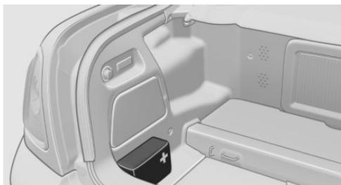
La trousse de premiers secours se trouve au niveau du plancher du compartiment à bagages sur la garniture latérale gauche.
