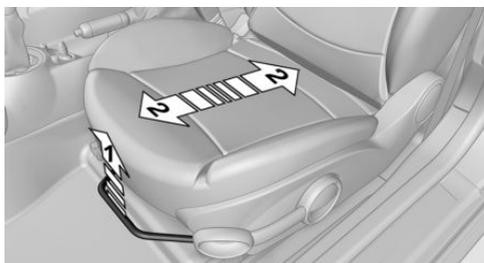
Tirer le levier, flèche 1, et pousser le siège sur la position souhaitée, flèches 2.
