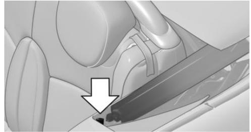
2. Pousser le cache dans le sens de la marche, flèche 1 et le dégager sur le côté, flèche 2. Le cas échéant, appuyer légèrement la garniture en plastique, flèche 3, vers l'intérieur.
