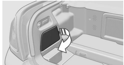
2. Tourner l'ampoule correspondante dans le sens antihoraire, flèche 1, et la retirer.
