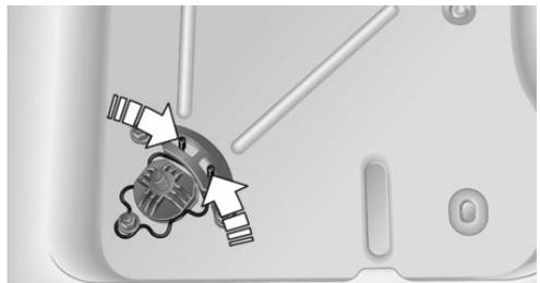
6. La roue compacte se détache et doit être maintenue avec la poignée de levage.
