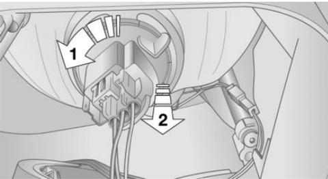
2. Appuyer sur le dispositif de déverrouillage, flèche 1, et débrancher le connecteur, flèche 2.
