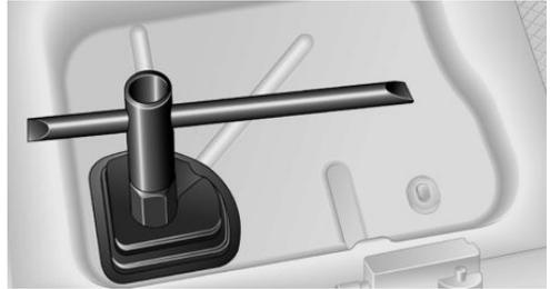
3. Visser la poignée de levage contenue dans l'outillage de bord sur le filetage.
