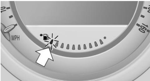
La flèche située à côté du symbole de pompe à essence sur la jauge à carburant, indique le côté du véhicule sur lequel se trouve la trappe du réservoir.
