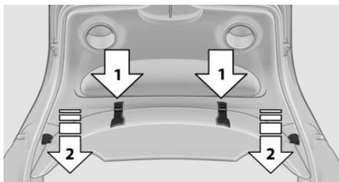
1. Déverrouillage, flèche 1, tirer à gauche et à droite.
