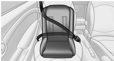
La ceinture de sécurité du passager avant peut être bloquée de sorte à ne plus pouvoir être tirée, permettant de fixer le système de retenue pour enfant.
