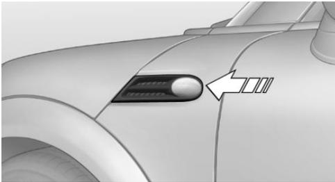
2. Tourner le support de l'ampoule dans le sens antihoraire et le retirer.
