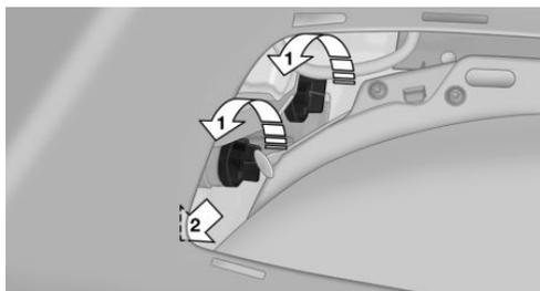
3. Pour installer l'ampoule neuve et remettre le cache, procéder dans l'ordre inverse.
