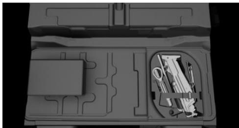
L'outillage de bord se trouve dans une cuvette sous le plancher de coffre à bagages.
