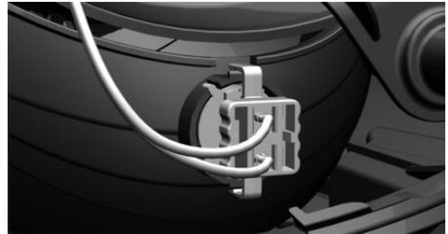
5. Tirer l'ampoule de la douille.
