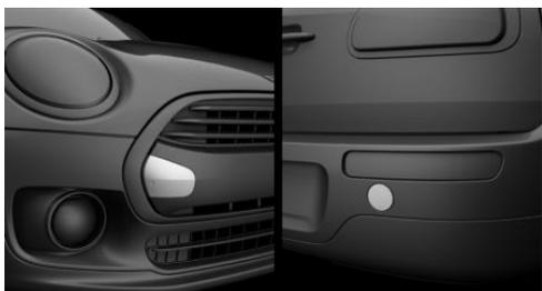
Les orifices filetés pour anneau de remorquage se trouvent à l'avant et à l'arrière du véhicule, à droite dans le sens de la marche.
