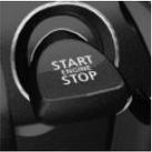
Une pression sur le bouton Start/Stop permet de mettre et de couper le contact ainsi que de mettre le moteur en marche.
