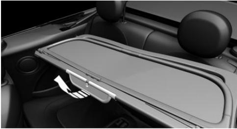
4. Pousser le coupe-vent vers l'intérieur et le haut, flèche 1, jusqu'à ce que le coupe-vent puisse être positionné devant les logements sur la face de montage.
