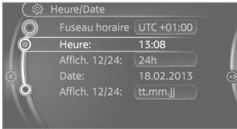
6. Tourner le Contrôleur pour régler les heures et appuyer sur le Contrôleur.
