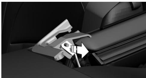
4. Dévisser deux vis, flèche, avec la clé Allen et les retirer.
