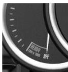
Le témoin signale que les conditions d'un arrêt automatique du moteur ne sont pas remplies.
