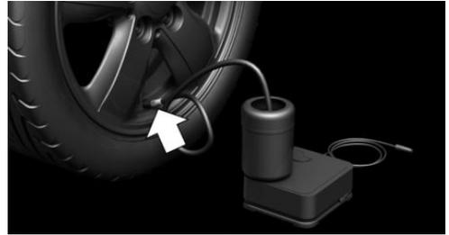
5. Tandis que le compresseur est encore éteint, brancher la fiche dans la prise de courant dans l'habitacle du véhicule.
