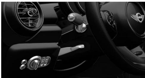
L'élément de commutateur d'éclairage se trouve à côté du volant.
