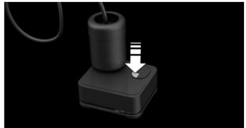
Laisser tourner le compresseur pendant 10 minutes maximum pour injecter le produit d'étanchéité et atteindre une pression de gonflage d'environ 2,5 bars.
