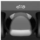
Repousser le commutateur vers l'arrière jusqu'à ce que le toit ouvrant soit ouvert.
