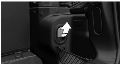
1. Tirer le levier dans le compartiment à bagages pour déverrouiller le dossier de siège arrière.
