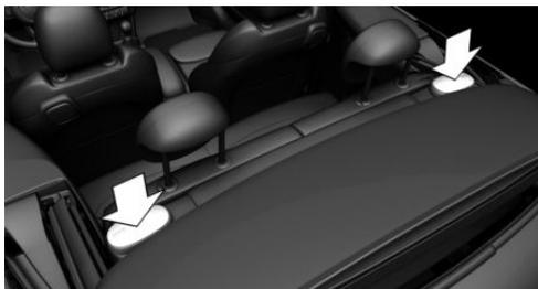
Ne pas place d'objets sur les caches du système de sécurité en cas de tonneau.
