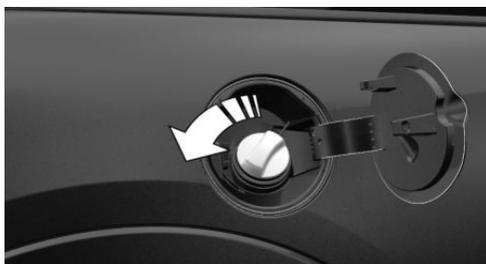
3. Placer le bouchon dans le support prévu sur la trappe du réservoir.
