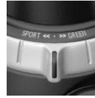
Tourner le commutateur d'expérience de conduite personnalisée à droite, jusqu'à ce que GREEN Mode apparaisse sur le combiné d'instruments.
