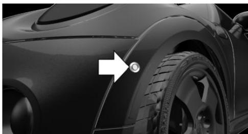
Les capteurs à ultrasons permettant de mesurer les espaces de stationnement libres se trouvent au niveau des passages de roue.
