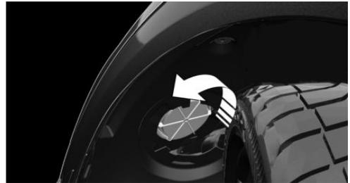
4. Retirer le porte-ampoule du boîtier de lampe, le cas échéant, le débloquer par de petits mouvements de va-et-vient.
