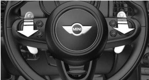
Les palettes de commande sur le volant permettent de changer rapidement de rapport, tandis que les mains peuvent rester sur le volant.
