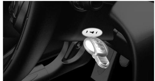
Boîte de vitesses automatique : en cas de message Check-Control correspondant, tenir la télécommande, comme représenté, au niveau du repère sur la colonne de direction et appuyer sur le bouton Start/Stop en l'espace de 10 secondes tout en appuyant sur la pédale de frein.
