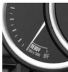
Le témoin signale que la fonction Start/Stop automatique est prête au démarrage automatique du moteur.
