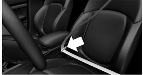
La boucle doit s'enclencher de façon franche et audible.
