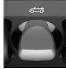
Repousser le commutateur vers l'avant et le maintenir actionné. Les vitres sont abaissées, la capote se ferme et les vitres sont de nouveau levées tant que l'on pousse le commutateur.
