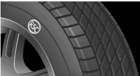
Identification RSC sur le flanc du pneu.
