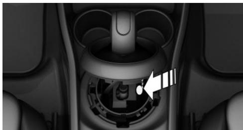
4. Déplacer légèrement la manette de sélection vers l'arrière ; actionner pour cela la touche Unlock à l'avant de la manette de sélection.
