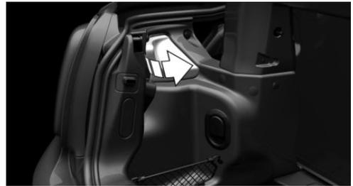
3. Par l'ouverture, débrancher la connexion, flèche 2, au niveau du support pour ampoule.
