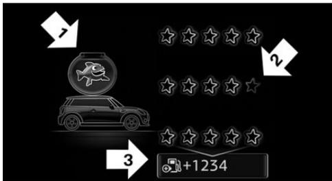
L'affichage de l'analyseur MINIMALISM consiste en un poisson embarqué dans un bocal rempli d'eau sur le toit de la MINI et en un tableau de valeurs qui apprécie le style de conduite dans différentes catégories. En dessous du tableau de valeurs s'affiche le supplément d'autonomie obtenu par un style de conduite limitant la consommation.
