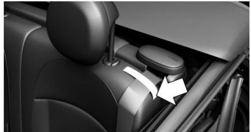
Lors du bouclage des ceintures de sécurité sur les sièges arrière, veiller à ce que la boucle de guidage de ceinture soit fermée.
