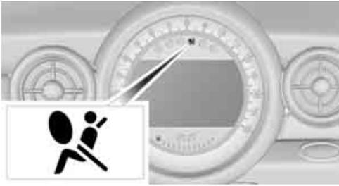
À partir de la transmission radio, voir page 51, le voyant d'alerte s'allume brièvement pour indiquer que tout le système de coussins gonflables et les tendeurs de ceintures fonctionnent.
