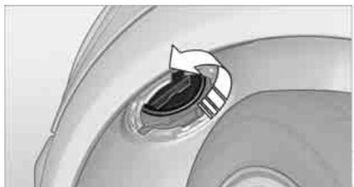
4. Dévisser l'ampoule dans le sens inverse des aiguilles d'une montre.
