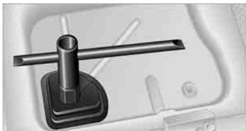
3. Visser la poignée de levage de l'outilage de bord du véhicule sur le filetage.
