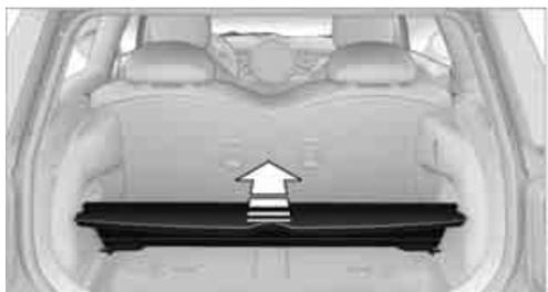
Relever le plancher de coffre plat et le replier vers l'avant, flèche.
