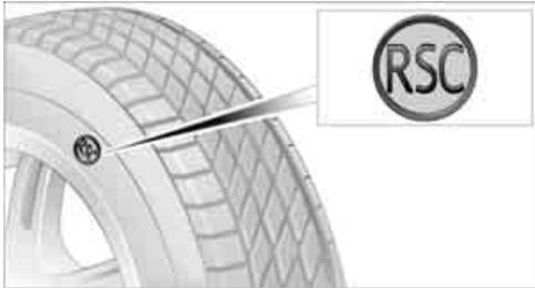
Les pneumatiques permettant de rouler à plat comportent un symbole circulaire contenant les lettres RSC sur la bande de roulement. Les pneumatiques permettant de rouler à plat comprennent un pneu autoportant et une jante spéciale. Grâce au renfort des flancs, la conduite demeure possible jusqu'à certaines limites en cas de crevaison.
