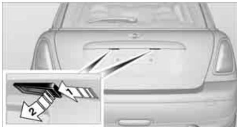
1. À l'aide d'un tournevis, enfoncer le feu vers la gauche dans la languette du logement du feu, flèche 1.
