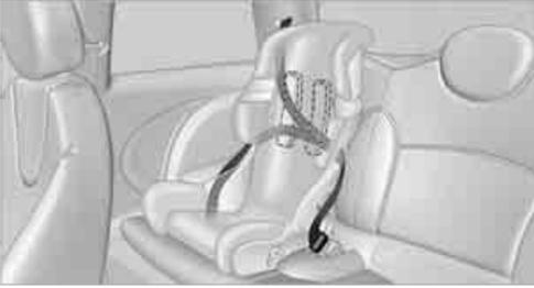
Les enrouleurs de toutes les ceintures de sécurité arrière et de la ceinture de sécurité du passager avant sont verrouillables pour permettre la fixation et l'arrimage d'un système de retenue pour enfant.
