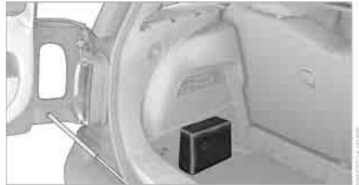
La trousse de secours se trouve sur le plancher de l'espace à bagages, à côté du panneau de garnissage gauche ou sous le plancher de coffre plat.
