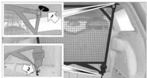
2. Insérer chaque goupille de fixation du filet pare-bagages jusqu'au fond dans sa fixation arrière respective dans la garniture de pavillon, flèche 1, et la pousser vers l'avant.
