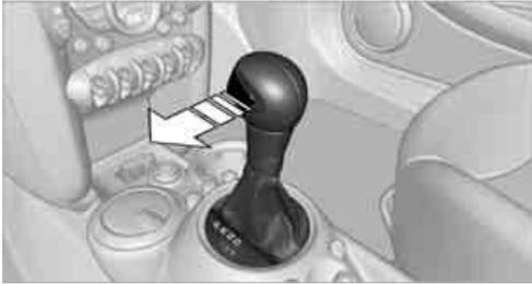
Déplacer le levier sélecteur de la position D vers la gauche, dans le plan M/S :
