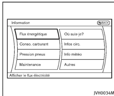
1. Appuyez sur le bouton INFO du panneau de commande et sélectionnez la touche «Flux énergétique» de l'affichage en utilisant la manette INFINITI. Appuyez ensuite sur le bouton ENTER.
