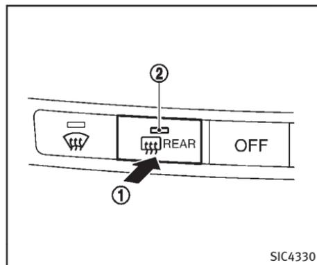
Pour désembuer ou dégivrer la lunette et les rétroviseurs extérieurs, démarrez le système hybride et appuyez sur la commande ① pour la mettre en position de marche. Le témoin indicateur ② va s'allumer. Appuyez de nouveau sur la commande pour arrêter le dégivreur.
