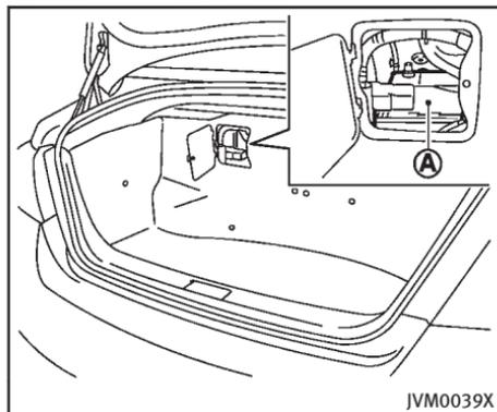
La batterie 12-volt (A) est située sur le côté gauche du coffre derrière un panneau d'accès.
