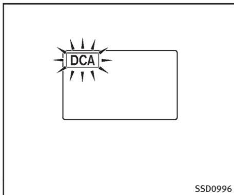
Sous les conditions suivantes, le système DCA ne fonctionne pas et le témoin indicateur de commande d'assistance au contrôle de distance DCA clignote :
