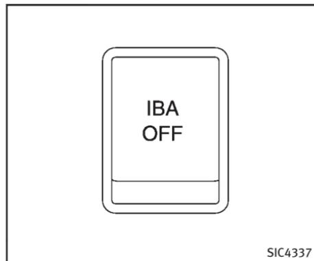
Dans la plupart des cas de conduite, il est préférable de mettre le système d'assistance au freinage intelligent (IBA) en marche.
