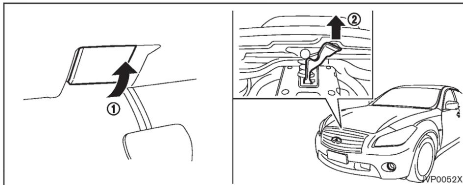
1. Tirez la poignée de déverrouillage du capot ① située sous le tableau de bord ; le capot se relèvera légèrement.
