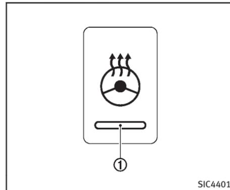
Le système de volant chauffant est conçu pour fonctionner uniquement lorsque la température de surface du volant est inférieure à 20°C (68°F).
