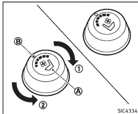
Le siège climatisé réchauffe ou refroidit les sièges avant en envoyant de l'air chaud ou frais depuis la surface du siège. Les commutateurs sont installés à l'intérieur de l'accoudoir central arrière et peuvent être commandés individuellement.
