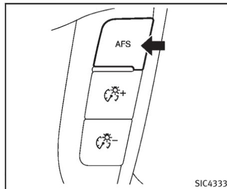
Appuyez sur la commande AFS pour désactiver cette fonction. (Le témoin indicateur de désactivation AFS s'allume.) Appuyez sur la commande à nouveau pour réactiver le système.
