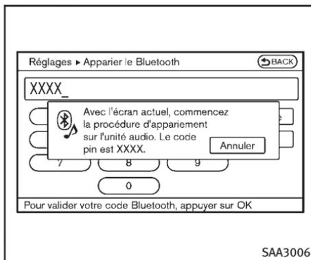
5. L'écran de message de veille apparaît. Actionnez le dispositif audio Bluetooth<sup>MD</sup> compatible. Pour la procédure de connexion du dispositif audio, reportez-vous aux instructions du système audio Bluetooth<sup>MD</sup>.
