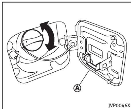
Pour retirer le bouchon du réservoir à carburant :
