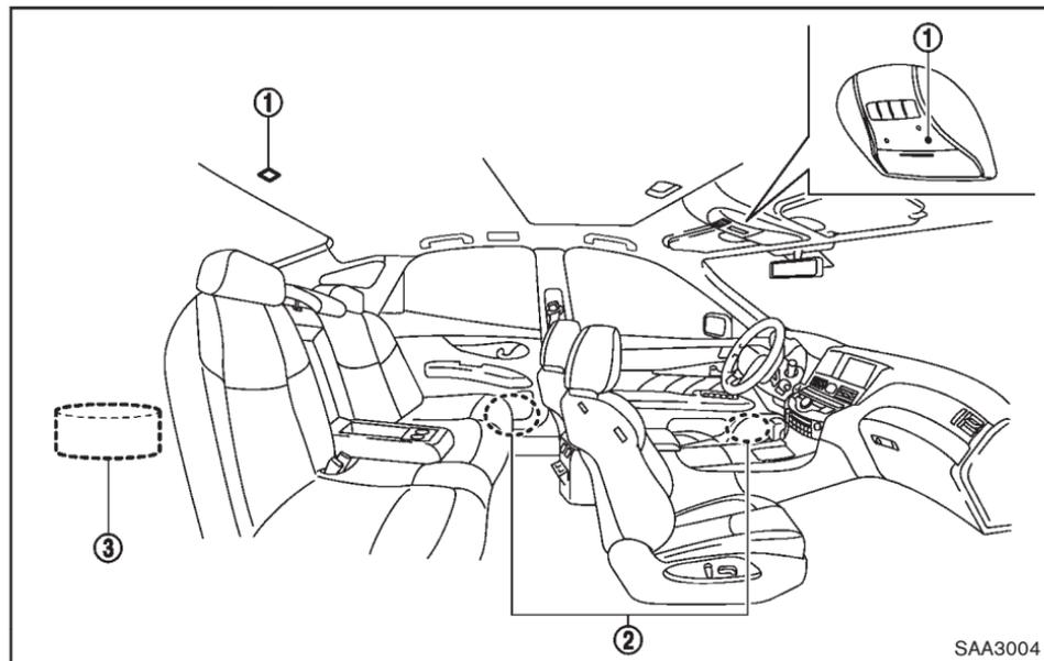
Ce système utilise des microphones ① situés à l'intérieur du véhicule pour détecter les bruits du moteur. Le système produit alors automatiquement un son pour étouffer la puissance du bruit du moteur à travers les haut-parleurs ② et le haut-parleur des graves ③ (si le véhicule
