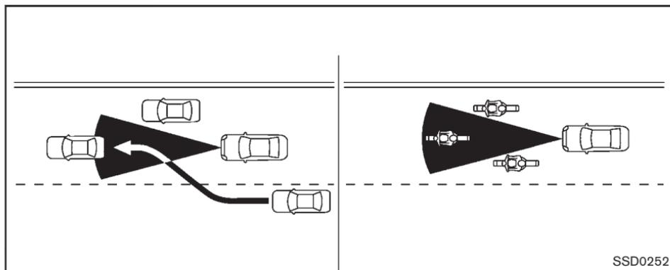
La zone de détection du système ICC est limitée. Le véhicule qui se trouve devant doit entrer dans la zone de détection du mode de détection de distance d'un véhicule à l'autre pour pouvoir être repéré et permettre de maintenir la distance entre véhicules auparavant sélectionnée.
