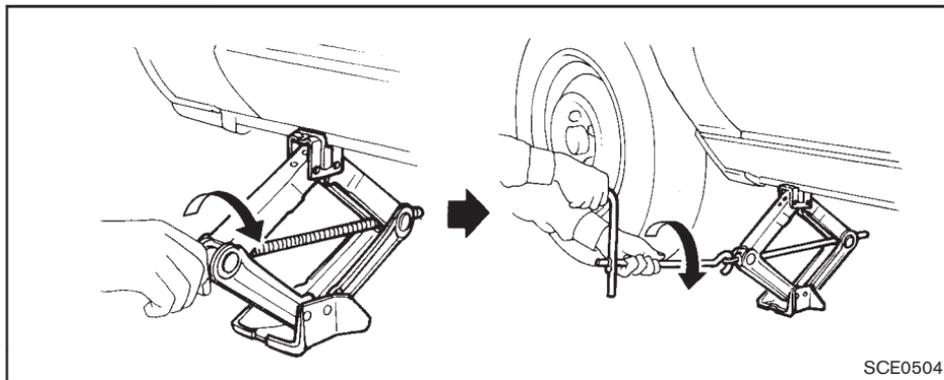
2. Desserrez tous les écrous de la roue, d'un ou deux tours, dans le sens inverse des aiguilles d'une montre avec la clé du cric. **Ne retirez pas les écrous tant que le pneu n'est pas délogé du sol.**
