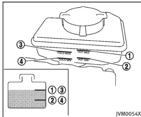
Vérifiez le niveau de liquide dans le réservoir.
