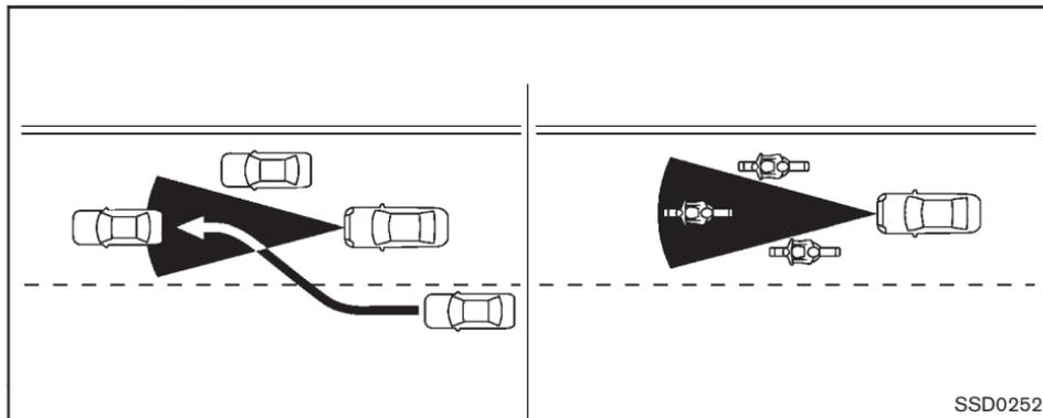
La zone de détection du capteur est limitée. Le véhicule précédant le vôtre doit se trouver dans la zone de détection pour que le système fonctionne.
