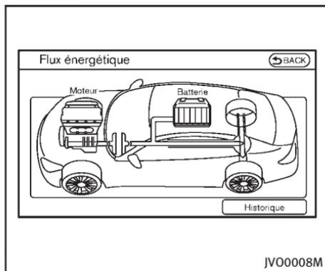
C'est un exemple de l'affichage de flux énergétique. L'affichage du flux énergétique change, selon les conditions de fonctionnement suivantes. Le graphique indique la quantité de puissance dans la batterie Li-ion.
