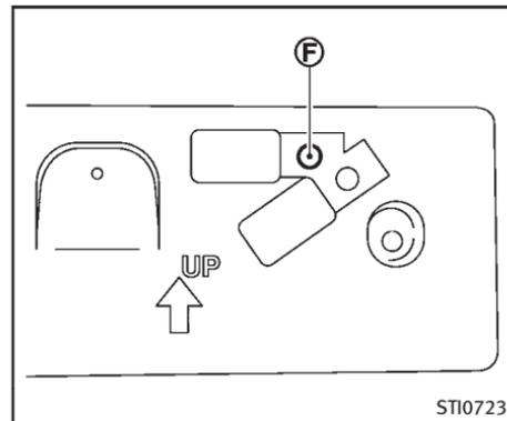
Marquez le point central (F) des deux orifices avec un feutre. Retirez les supports du pare-chocs, puis pratiquez des orifices de 20 mm (0,79 po) de diamètre dans le pare-chocs, en utilisant les repères (F) comme point central.
