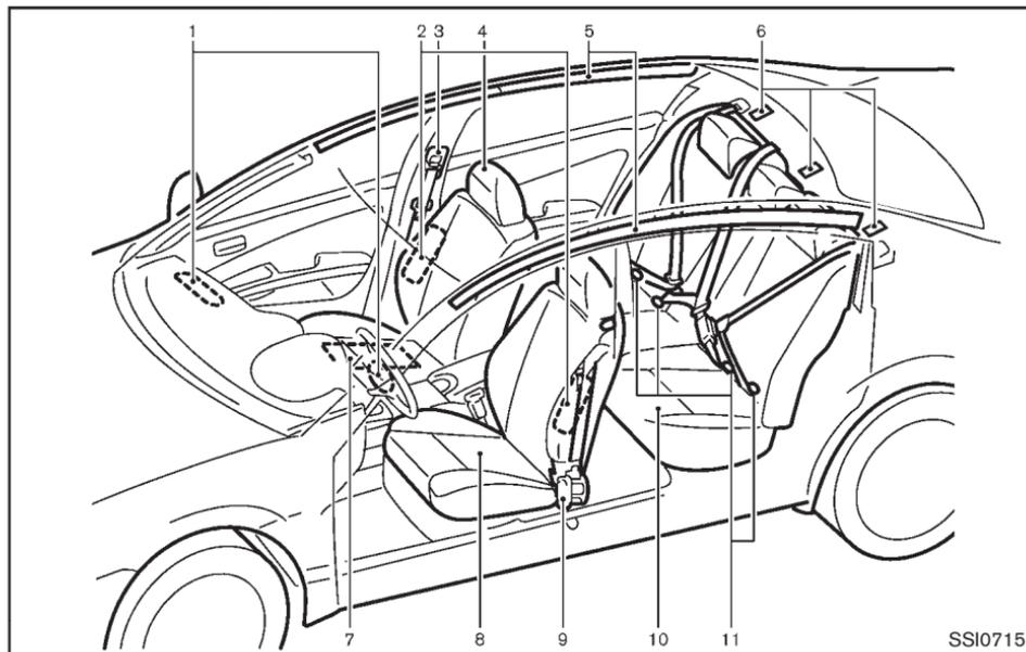
7. Capteur de classification d'occupant (capteur de forme) (P.1-49)
