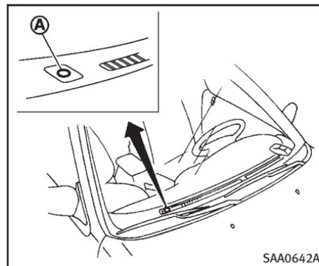
**Ne couvrez pas le photocapteur (A) situé en haut du tableau de bord. Le photocapteur commande l'éclairage automatique, s'il est couvert, il réagira comme s'il faisait noir et les phares s'allumeront.**
