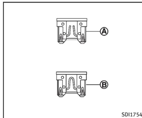
5. Si le fusible a sauté (A), remplacez-le par un fusible neuf (B). Les fusibles de rechange sont rangés dans la boîte à fusibles de l'habitacle.
