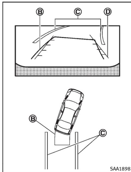
3. Reculez doucement le véhicule tout en bougeant le volant de façon à ce que les lignes d'alignement calculées (B) entrent dans la place de parking (C).
