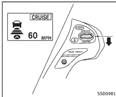
**Pour régler une vitesse de croisière,** accélérez votre véhicule jusqu'à la vitesse voulue, appuyez sur la commande COAST/SET et relâchez-la. (L'indicateur de présence de véhicule, l'indicateur de distance sélectionnée et l'indicateur de vitesse constante sélectionnée s'allument.) Enlevez votre pied de la pédale d'accélérateur. Le véhicule est maintenu à la vitesse mémorisée.
