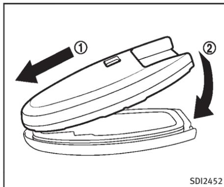
4. Aligned les extrémités des parties inférieures et supérieures, puis mettez-les une dans l'autre jusqu'à ce que le tout soit bien fermé.
