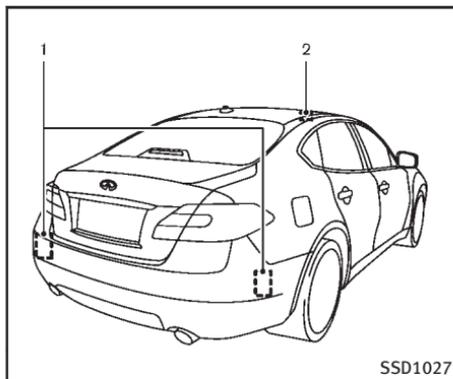
Le système BSW utilise des capteurs radar ①, installés à proximité du pare-chocs arrière pour détecter les véhicules se trouvant à côté de votre véhicule sur une voie adjacente. En plus des capteurs radar, le système BSI utilise une caméra ② installée à l'arrière du pare-brise pour surveiller les marquages de voie de votre voie de circulation.
