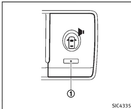
La commande des systèmes d'assistance est utilisée pour allumer et éteindre les systèmes d'assistance (Systèmes d'avertissement de collision avant (FCW), d'avertissement du déport de couloir (LDW) et d'avertissement d'angle mort (BSW)) qui sont activés en utilisant le menu de réglages sur l'affichage central.
