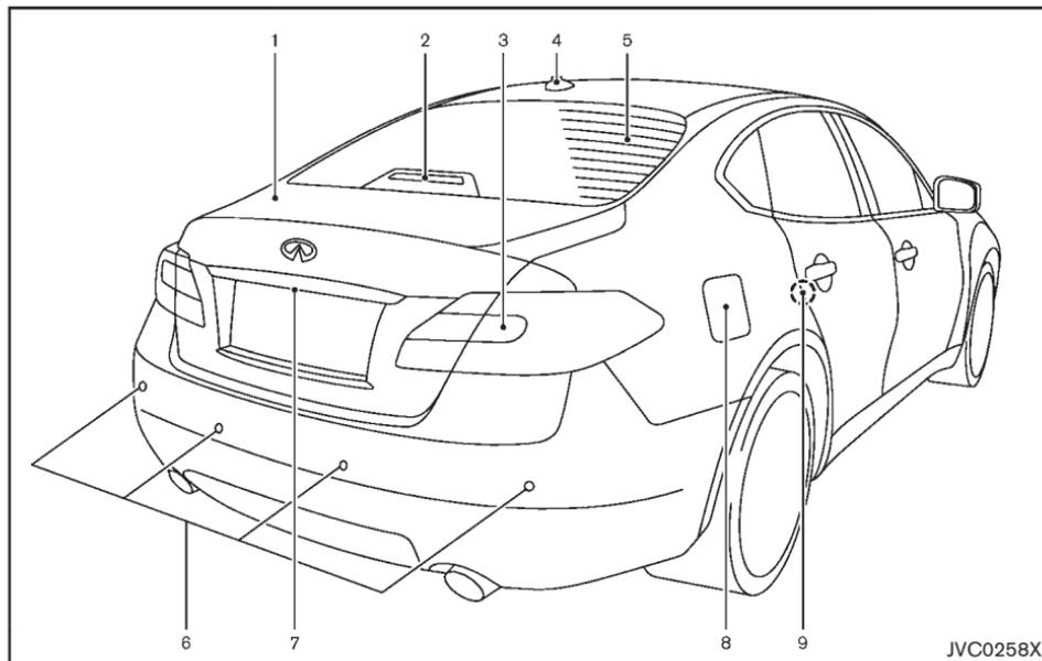
6. Système de sonar (si le véhicule en est équipé) (P.5-99)
