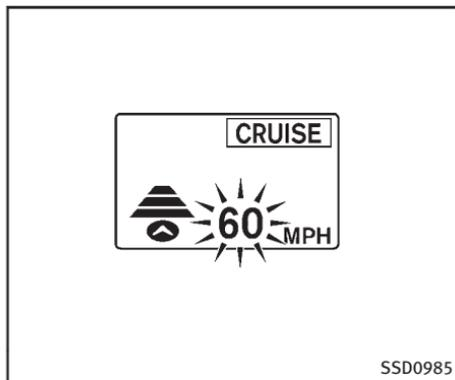
**Dépassant un autre véhicule**, l'indicateur de vitesse constante sélectionnée s'éclaire lorsque le véhicule roule à une vitesse supérieure à la vitesse définie. L'indicateur de détection de véhicule s'arrête lorsque la voie devant le véhicule est ouverte. Lorsque la pédale est relâchée, le véhicule reviendra à la vitesse constante précédemment réglée.
