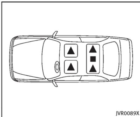
L'illustration indique les positions de siège équipées d'appui-tête.
