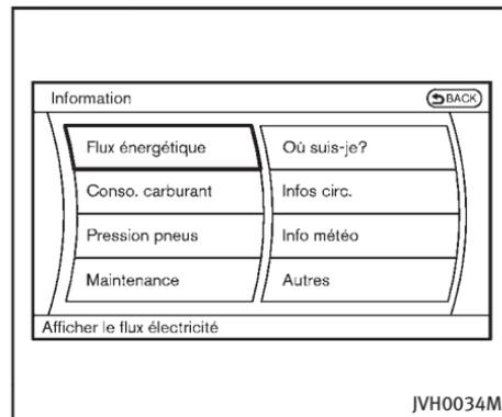
Appuyez sur le bouton INFO du panneau de commande et sélectionnez la touche «Flux énergétique» de l'affichage en utilisant la manette INFINITI puis appuyez sur le bouton ENTER.
