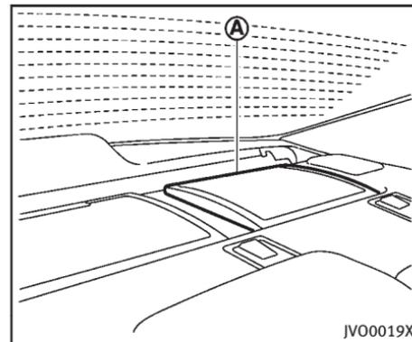
Une bouche d'air **A** est située sur la plage arrière pour refroidir la batterie Li-ion. Si la bouche est recouverte, la batterie surchauffe, ce qui réduit les performances de rendement du système hybride. Reportez-vous à «Bouche d'air de batterie au lithium-ion (Li-ion)» (P.7-6).
