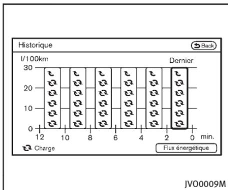
L'Historique de la consommation de carburant peut être affiché sur le moniteur du système de navigation. Cela affiche la consommation de carburant moyenne du véhicule et la puissance électrique régénérative par intervalles de 2 minutes.
