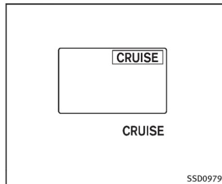
Lorsque le contacteur d'allumage est réglé sur ON, les témoins indicateurs s'allument comme illustré pour pouvoir vérifier la présence d'ampoules grillées et il s'éteint après le démarrage du système hybride.
