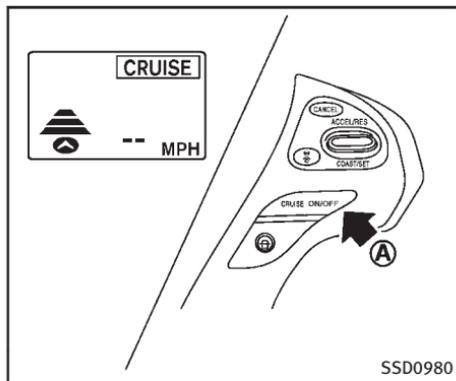
Utilisation du mode de contrôle de distance d'un véhicule à l'autre
