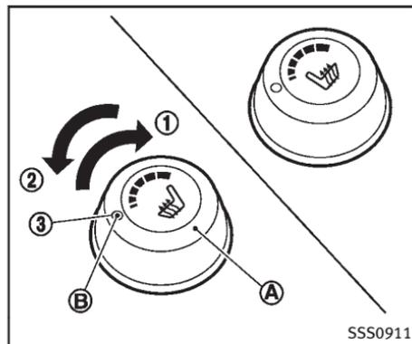
Les sièges avant sont chauffés grâce à un dispositif de chauffage incorporé. Les commutateurs sont installés à l'intérieur de l'accoudoir central arrière et peuvent être commandés individuellement.
