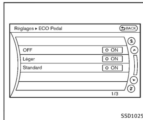
3. Pour régler la force de réaction du système de pédale ECO, sélectionnez «Standard» ou «Léger».
