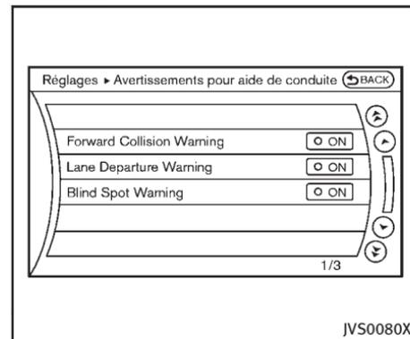
3. Sélectionnez l'option «Avertissement de collision avant», sélectionnez **ON** (activé) ou **OFF** (désactivé) et appuyez sur le bouton **ENTER** ②.
