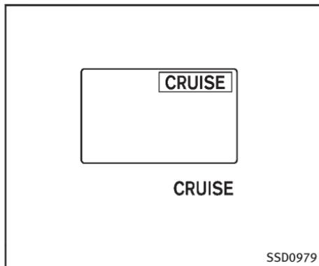
Lorsque les réglages ne sont pas possibles ou que le témoin indicateur reste allumé, cela pourrait signifier qu'il y a une anomalie du système ICC. Le véhicule reste utilisable dans des conditions normales, mais il est préférable de le faire vérifier par un détaillant INFINITI.
