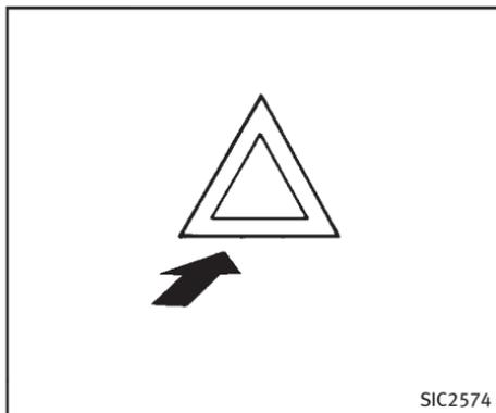
Appuyez sur l'interrupteur pour avertir les autres usagers de la route lorsque le véhicule doit être immobilisé en cas d'urgence. Tous les clignotants fonctionnent simultanément.
