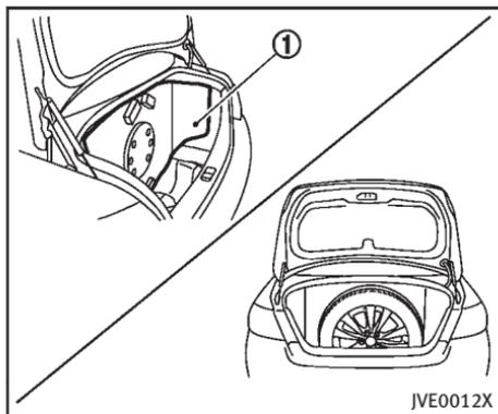
6. Mettez le couvercle de plancher du coffre ① contre le coffre et rangez le pneu endommagé.
