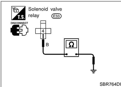
**ABS SOLENOID VALVE RELAY GROUND**
