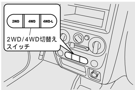
2WD/4WD切替えスイッチを操作して切り替えた駆動状態は、メーター内の4WD表示灯および4L表示灯で確認できます。駆動切替え中は、操作したスイッチに応じて4WD表示灯または4L表示灯が0.5秒間隔でゆっくり点滅します。
