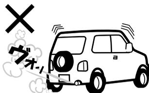
走行中は車速に応じたギヤで低速ギヤを使って高いエンジン回転速度（回転数）で走行すると燃費が悪くなります。走行速度に応じた正しいギヤをお使いください。
