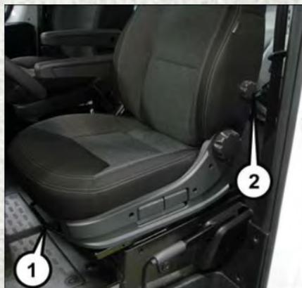
**Commandes vers l'avant et vers l'arrière et commandes du support lombaire**
