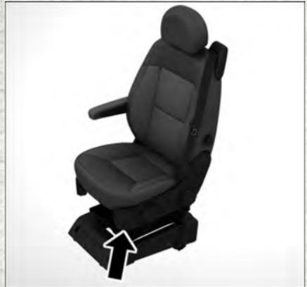
Levier du dispositif d'inclinaison
