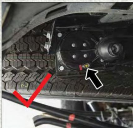
Mécanisme de treuil enclenché correctement (un POINT jaune s'affiche dans la fenêtre d'indication du treuil)
