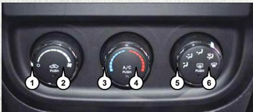
Commandes du système de chauffage-climatisation manuelles
