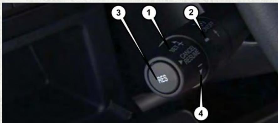
Levier de contrôle électronique de vitesse
