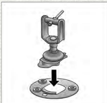
**Assemblage de l'adaptateur et du support**
