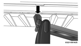
**Aligning Gate To Slots**
