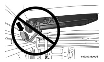
**Improper Clamp Position**
