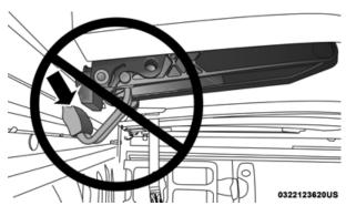
**Improper Clamp Position**
