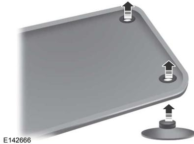
Pour poser les tapis, placez l'œillet du tapis par-dessus la tige de fixation et appuyez pour le bloquer en place.
