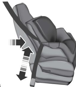
10. Avant d'asseoir l'enfant, essayez de faire balancer le siège de l'avant vers l'arrière pour vous assurer qu'il est bien fixé. Empoignez le siège et la courroie et tentez de déplacer le siège latéralement, puis vers l'avant et vers l'arrière. Si l'installation est adéquate, vous ne devriez pas être en mesure de déplacer le siège sur une distance de plus de 2,5 cm (1 po).
