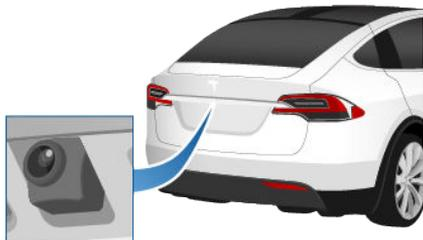
Ogni volta che si innesta la marcia Reverse, sul touchscreen viene visualizzata la vista della telecamera. Le linee di guida mostrano il percorso di marcia in base alla posizione del volante. Tali linee di guida si adattano a seconda del movimento del volante.
