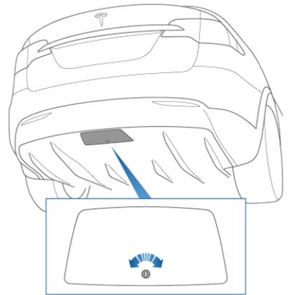
2. Inserire la chiave nel cilindro di bloccaggio del gancio e ruotare il cilindro in modo tale da allineare il lato superiore della chiave alla posizione "sbloccato".
