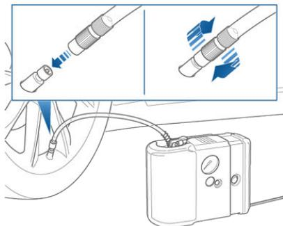
6. Rimuovere il cappuccio rosso e avvitare l'estremità del tubo flessibile sulla valvola dello pneumatico.
