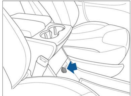
Le prese da 12 V sono adatte per accessori con un assorbimento continuo di 11 A (15 A di picco) o fino a un massimo di 150 watt continui (180 watt di picco).
