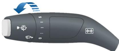
Per azionare una volta sola i tergicristalli, premere e rilasciare l'estremità della leva.
