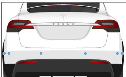
Les capteurs sont activés si vous conduisez à une vitesse inférieure à 8 km/h.
