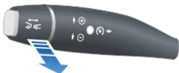
Remarque : Selon la date de fabrication, certains Model X présentent un bouton à l'extrémité du levier du régulateur de vitesse. Appuyez sur ce bouton lorsque le régulateur de vitesse est actif pour annuler le régulateur de vitesse.
