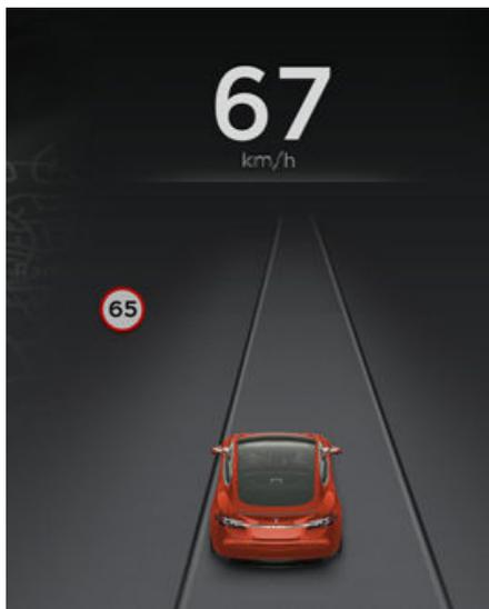
Lorsque l'indicateur de limite de vitesse ne parvient pas à déterminer de limite de vitesse (panneaux de signalisation ou données GPS indisponibles), ou qu'il n'est pas certain de la limite de vitesse détectée (en cas d'absence de panneau pendant un certain temps, par exemple), le tableau de bord peut ne pas afficher de signal de limite de vitesse et les avertissements ne sont pas actifs.
