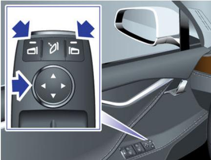
Pour rabattre et déployer les rétroviseurs extérieurs, appuyez sur le bouton central. Vous pouvez paramétrer les rétroviseurs pour qu'ils se rabattent automatiquement lorsque vous verrouillez la Model X. Pour cela, touchez Contrôles > Paramètres > Véhicule > Rabattement auto > ACT..
