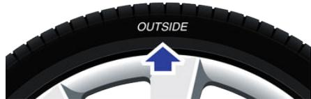
**⚠ Avertissement :** La tenue de route est sérieusement compromise si les pneus ne sont pas bien montés sur les roues.
