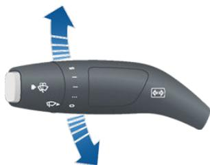
Les clignotants cessent de fonctionner lorsque le volant revient en position droite ou lorsque vous reprenez le levier dans sa position centrale.
