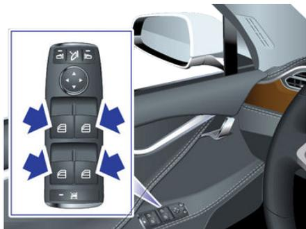
De même, tirez la commande vers le haut pour fermer la vitre correspondante. La fermeture fonctionne aussi en deux niveaux — pour fermer une vitre, maintenez la commande et relâchez-la lorsque la vitre atteint l'ouverture souhaitée.
