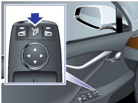
Il retrovisore esterno del conducente si regola automaticamente di notte, in base al livello di riverbero prodotto dai fari dei veicoli che seguono (tranne quando è inserita la marcia Reverse). Entrambi i retrovisori esterni sono inoltre dotati di riscaldatori che si attivano e disattivano insieme al sistema di sbrinamento del lunotto.
