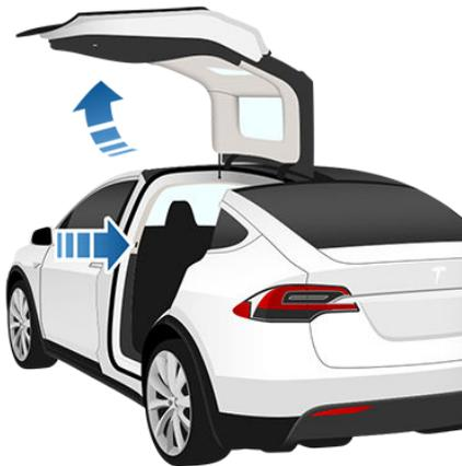
**Nota:** se la Model X è bloccata, utilizzando l'interruttore (raffigurato sopra) una prima volta la portiera associata si sblocca. Tirando una seconda volta si apre.
