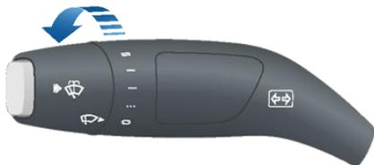
Per azionare una volta sola i tergicristalli, premere e rilasciare l'estremità della leva.
