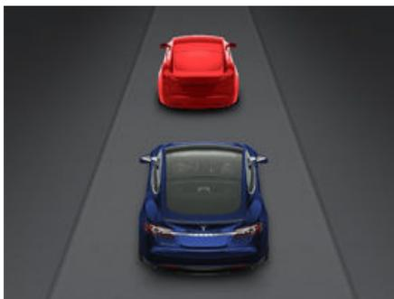
Gli avvertimenti vengono annullati automaticamente quando il rischio di collisione si riduce (ad esempio, se si riduce la velocità o si arresta la Model X oppure quando un veicolo esce dal percorso di marcia).
