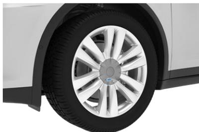
Per installare il copri bullone ruota, allinearli in posizione e premere saldamente fino a quando risulta completamente bloccato.
