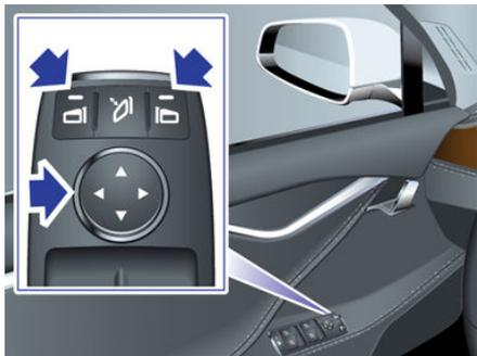
Per chiudere e aprire i retrovisori esterni, premere il pulsante centrale. Per impostare la chiusura automatica dei retrovisori esterni quando ci si allontana dalla Model X, toccare **Controls > Settings > Vehicle > Mirror Auto-Fold > ON**. I retrovisori si aprono automaticamente sbloccando la Model X.
