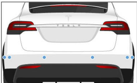
I sensori si attivano quando si procede a una velocità inferiore a 8 km/h.
