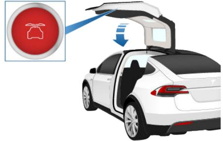
**Nota:** Per impedire ai bambini di aprire le portiere ad ali di gabbiano Falcon con l'interruttore interno, attivare il blocco portiere toccando (**Controls > Settings > Doors & Locks > CHILD-PROTECTION LOCK**). Vedere [Blocco portiere per protezione bambini](#) alla pagina 11.
