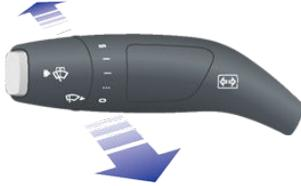
Las Luces largas pueden cambiar automáticamente a luces de cruce si se detecta luz delante del Model X (por ejemplo, procedente de un vehículo circulando en dirección contraria). Para activar esta función, toque **Controles > Luces largas**.
