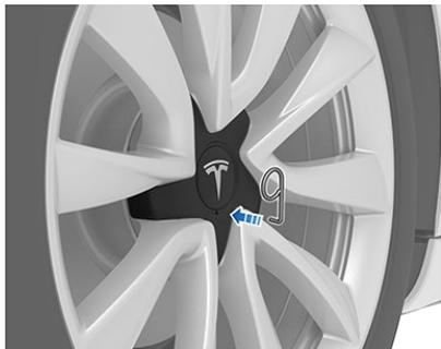
2. Utilisez l'outil du cache d'écrou de roue afin qu'il soit entièrement inséré dans le trou du cache d'écrou de roue.
