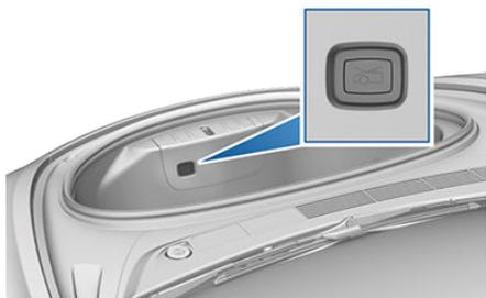
Appuyez sur le bouton de déverrouillage intérieur pour ouvrir le coffre puis levez le capot.
