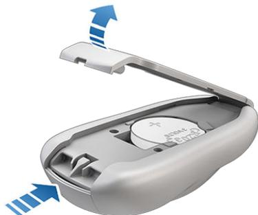
2. Retirez la pile en l'extrayant des clips de retenue.
