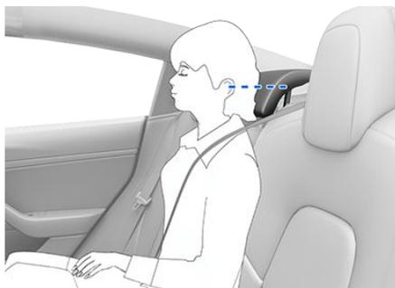
L'appuie-tête du siège central arrière doit toujours être abaissé si vous installez un siège pour enfant retenu par la ceinture de sécurité. Voir [Relevage/abaissement de l'appuie-tête central arrière](#) à la page 27.
