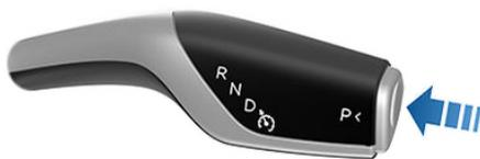
Model 3 passe automatiquement en mode P (stationnement) lorsque vous connectez un câble de recharge ou si deux des conditions suivantes, ou plus, sont réunies simultanément :
