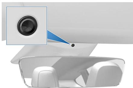
La lentille de la caméra doit être propre et dégagée. Retirez toute accumulation de saletés ou de poussière en essuyant de temps en temps la lentille de la caméra avec un chiffon doux humide.
