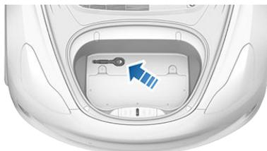
3. Retirez la protection de l'anneau de remorquage en appuyant fermement sur la zone supérieure droite de la protection jusqu'à ce qu'elle pivote, puis tirez doucement vers vous sur la section relevée.
