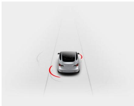
L'Aide au maintien de voie vous avertit lorsqu'elle détecte un franchissement de ligne involontaire en faisant légèrement vibrer le volant lorsque l'une des roues avant sort de la voie alors que les clignotants n'ont pas été actionnés. Cet avertissement est actif uniquement lorsque vous roulez à une vitesse entre environ 36 et 90 mph (59 et 150 km/h). Pour activer ou désactiver cet avertissement, touchez **Contrôles > Autopilot >**
