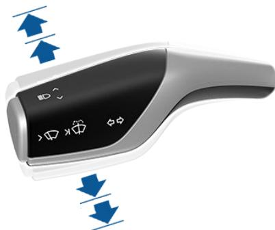
Les clignotants cessent de fonctionner lorsque le volant revient en position droite ou après avoir déplacé le levier dans le sens inverse.
