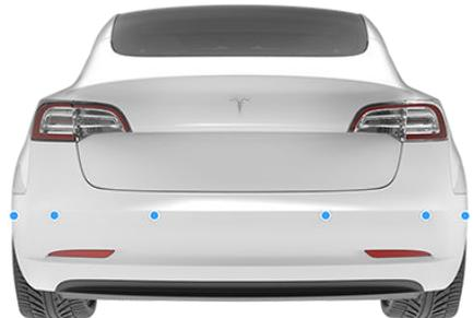
Les capteurs sont activés si vous conduisez à une vitesse inférieure à 5 mph (8 km/h).
