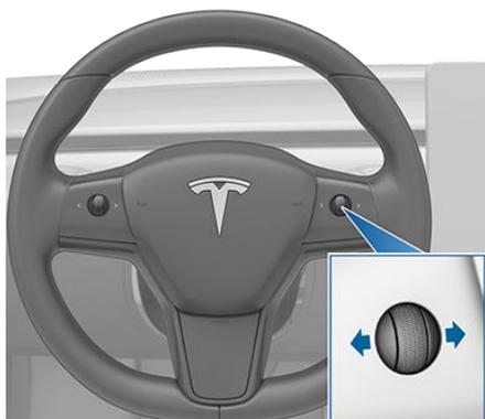
Vous pouvez également afficher et régler, à tout moment, la distance de sécurité sur l'écran tactile, même si le Régulateur de vitesse dynamique n'est pas actif. Appuyez sur **Contrôles > Autopilot > Distance de sécurité du régulateur**, puis ajustez la distance de sécurité en appuyant sur le bouton plus (+) ou moins (-).
