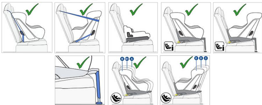
Vous pouvez installer les nourrissons et les enfants dans les sièges latéraux arrière en utilisant soit un dispositif de retenue reposant sur la ceinture soit un dispositif ISOFIX/i-Size. Sur les sièges latéraux arrière, vous pouvez utiliser les dispositifs de retenue pour enfants reposant sur la ceinture, ISOFIX (IU) et i-Size (i-U) orientés vers l'avant et ceux orientés vers l'arrière. Les sièges latéraux arrière sont compatibles avec les catégories de tailles ISOFIX suivantes :
