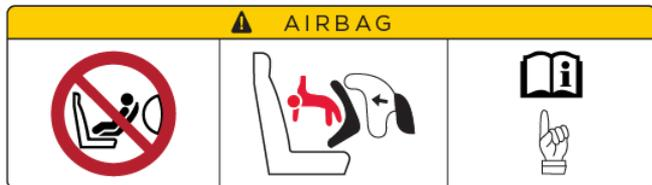
Lorsqu'un nourrisson ou un enfant est assis dans le siège passager avant (y compris lorsque l'enfant est installé à l'aide d'un dispositif de retenue ou dans un rehausseur pour enfants adéquats), l'airbag frontal passager DOIT être désactivé. En cas de collision, le déploiement de l'airbag peut entraîner des blessures graves, voire mortelles, surtout si vous utilisez un dispositif de retenue pour enfants orienté vers l'arrière.
