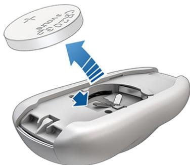
3. Insérez la pile neuve (type CR2032) avec le côté + orienté vers le haut.
