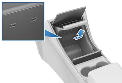
Deux autres ports USB sont situés à l'arrière de la console centrale. Les passagers arrière peuvent utiliser ces ports pour charger leurs appareils à connexion USB. Le Lecteur multimédia ne communique pas avec les ports USB arrière.
