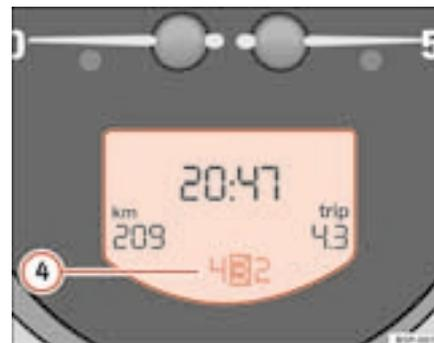
Fig. 37 Pormenor do painel de instrumentos: visor com indicador das velocidades do Tiptronic
