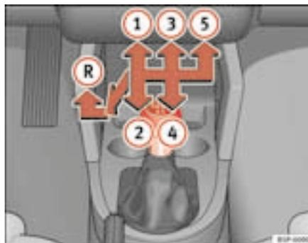
Fig. 131 Pormenor da consola central: esquema de uma caixa de manual com 5 velocidades
