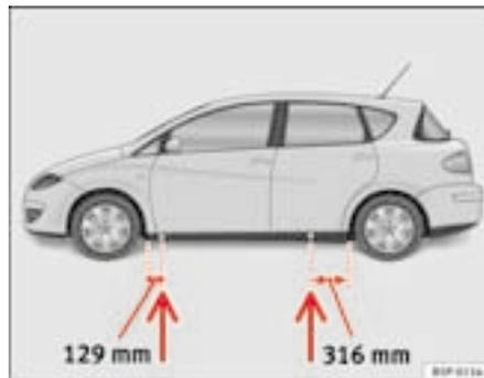
Fig. 171 Pontos de recepção do macaco
