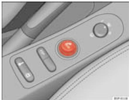
Fig. 114 Isqueiro alojado na tomada de corrente da consola central dianteira
