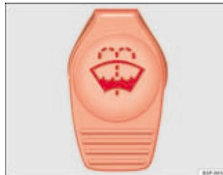
**Fig. 161** Tampão do depósito do limpa-vidros no compartimento do motor.
