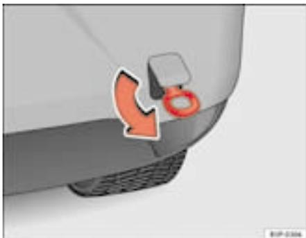
Fig. 200 Enroscar a argola de reboque de trás
