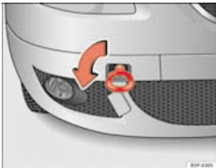
Fig. 199 Enroscar a argola de reboque na parte dianteira direita do veículo
