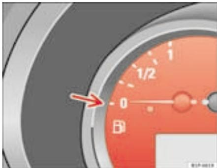
Fig. 34 Painel de instrumentos: indicador do nível do combustível
