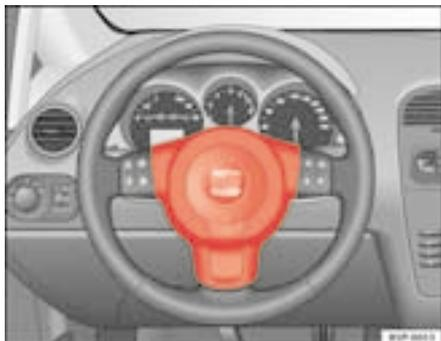
**Fig. 18** Airbag do condutor no volante
