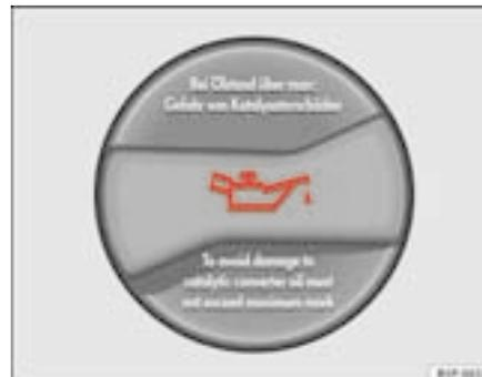
**Fig. 159** Tampão da abertura de enchimento do óleo do motor no compartimento do motor
