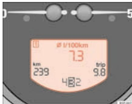
Fig. 42 Visor digital do painel de instrumentos: indicador do consumo médio de combustível.
