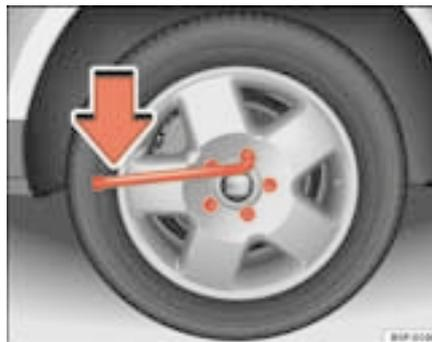
**Fig. 170** Substituição de uma roda: desapertar os parafusos das rodas
