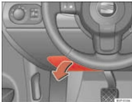
**Fig. 175** Tampa da caixa dos fusíveis no lado esquerdo do painel de instrumentos
