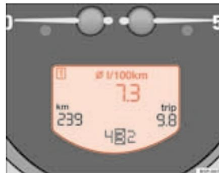
Fig. 40 Visor digital do painel de instrumentos: indicador do consumo médio de combustível
