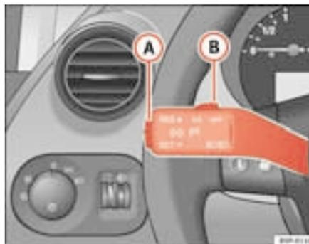
Fig. 142 Alavanca dos indicadores de direcção e máximos: comando e interruptor basculante para o regulador de velocidade
