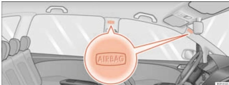
**Fig. 24** Localização de montagem dos airbags da cabeça do lado esquerdo do veículo
