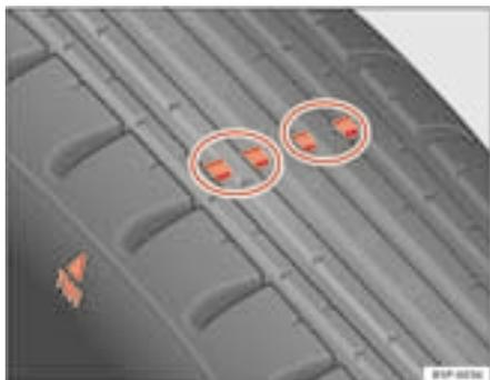
**Fig. 166** Perfil do pneu: indicador de desgaste
