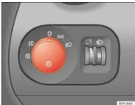
Fig. 73 Pormenor do painel de instrumentos: comando das luzes, faróis de nevoeiro e a luz traseira de nevoeiro
