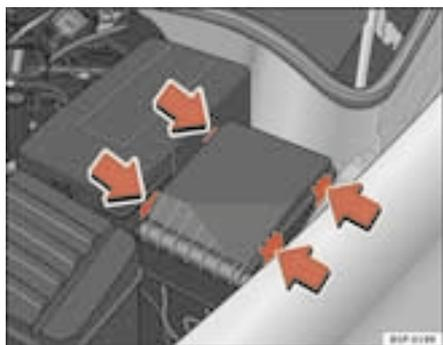
**Fig. 176** Tampa da caixa de fusíveis no compartimento do motor
