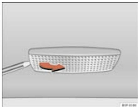
Fig. 196 Desmontagem da luz da pala do sol
