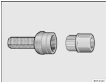
Fig. 174 Parafusos anti-roubo das rodas
