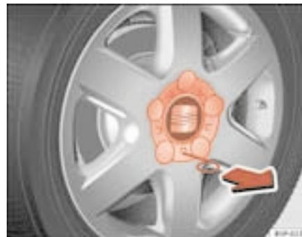
**Fig. 169 Trocar a roda: retirar os tampões das rodas**
