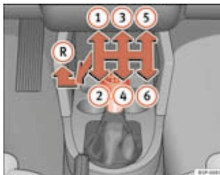
Fig. 132 Pormenor da consola central: esquema de uma caixa de manual com 6 velocidades
