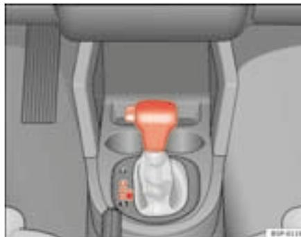
**Fig. 135** Desactivação do bloqueio
