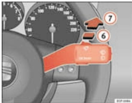
Fig. 87 Alavanca do limpa/lava-vidros: limpa-vidros traseiro
