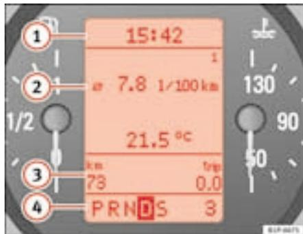
Fig. 38 Visor digital no painel de instrumentos
