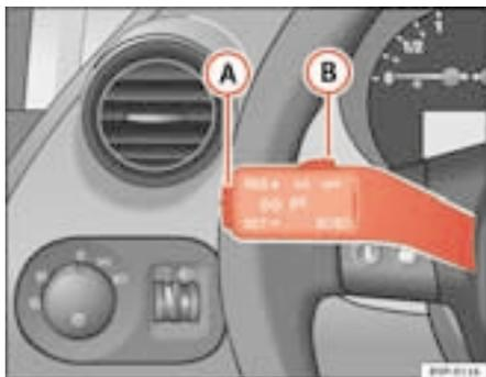
Fig. 139 Alavanca dos indicadores de direcção máximos: comando e interruptor basculante para o regulador de velocidade
