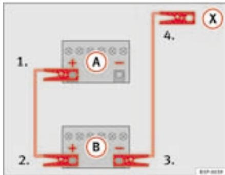
Fig. 198 Esquema de ligação dos cabos auxiliares do arranque
