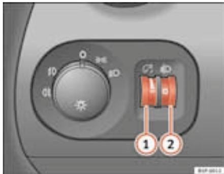
Fig. 75 Painel de instrumentos: reguladores da iluminação dos instrumentos, dos comandos e do alcance dos faróis
