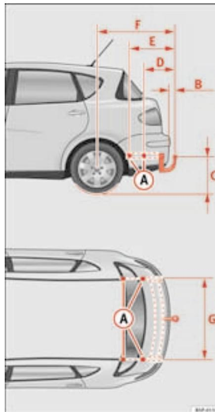
Fig. 153 Pontos de fixação do dispositivo de reboque
