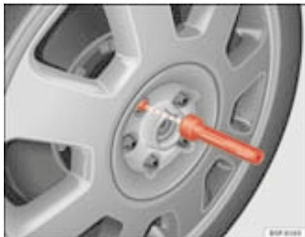
Fig. 173 Troca da roda: utensílio de sextavado interior para desapertar e apertar os parafusos
