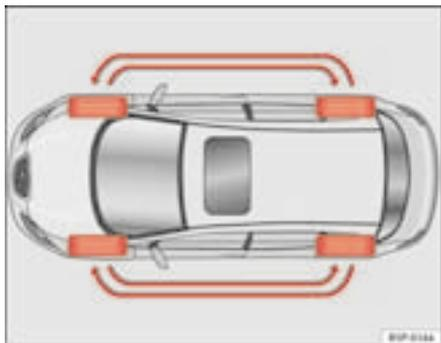
**Fig. 167** Esquema de troca dos pneus
