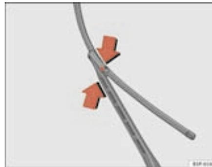
**Fig. 163** Substituição das escovas do limpa-vidros
