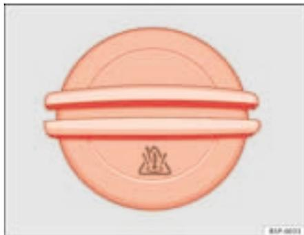
Fig. 160 Tampão do reservatório de expansão do líquido de refrigeração no compartimento do motor
