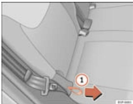
Fig. 96 Regular a inclinação do encosto, banco traseiro
