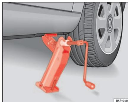
**Fig. 168** Posizionamento del cric
