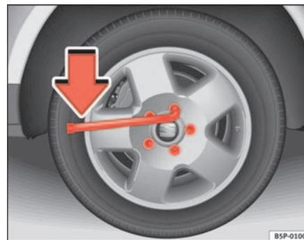
Fig. 166 Cambio di una ruota: come allentare le viti
