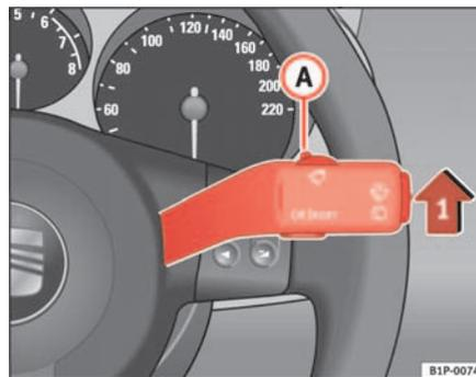
Fig. 87 Leva dell'impianto tergicristalli ▶
