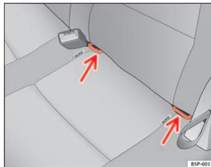
**Fig. 31** Maniglie di fissaggio del sistema ISOFIX
