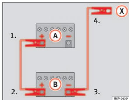
Fig. 194 Schema per il collegamento dei cavi per l'avviamento di emergenza
