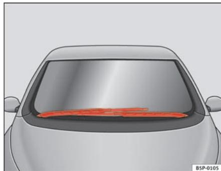
Fig. 158 Tergicristallo in posizione di manutenzione
