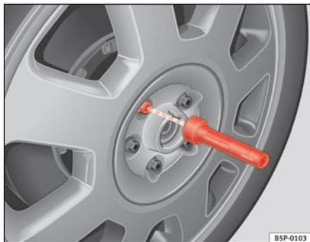
**Fig. 169** Cambio della ruota: esagono cavo per svitare le viti
