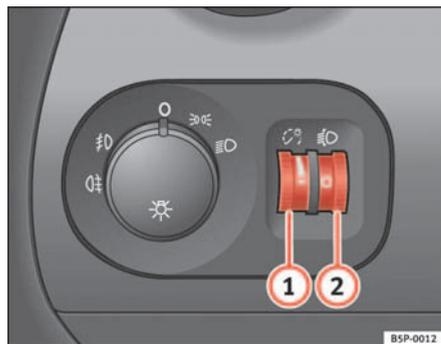
Fig. 76 Plancia portastrumenti: regolatore dell'intensità di illuminazione degli strumenti e degli interruttori e regolatore assetto fari
