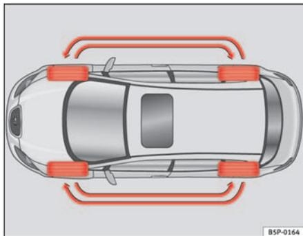
**Fig. 163** Schema per lo scambio delle ruote
