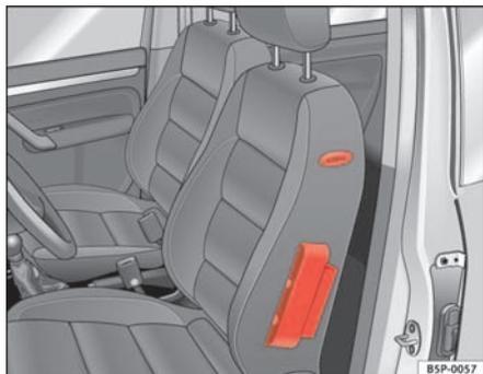
**Fig. 22** Airbag laterale all'interno del sedile del conducente
