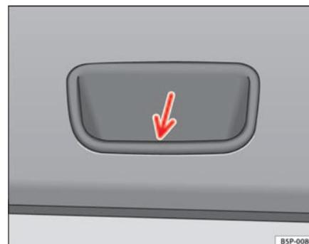
**Fig. 68** Dettaglio del rivestimento interno del portellone posteriore: maniglia di presa ad incavo
