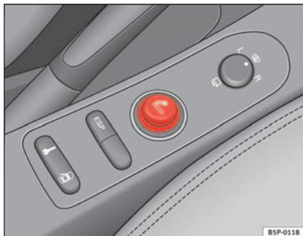
Fig. 114 Accendisigari all'interno della presa di corrente della console centrale anteriore
