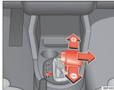
**Fig. 137** Cambio del rapporto di marcia con Tiptronic
