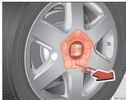
**Fig. 165** Cambio di una ruota: rimuovere il coprimozzo della ruota
