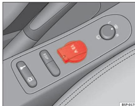
Fig. 115 Presa di corrente console centrale anteriore
