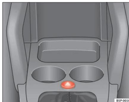
Fig. 77 Plancia portastrumenti: interruttore del lampeggio d'emergenza
