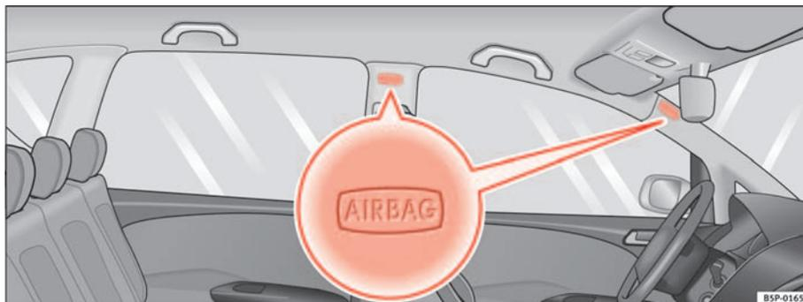
**Fig. 24** Ubicazione degli airbag per la testa, lato sinistro del veicolo
